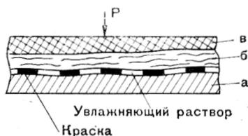
Рис. 11. Схема контакта поверхности бумаги с резиноканевой пластиной:
