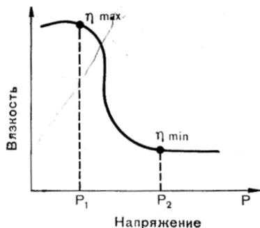
Рис. 29. Изменение вязкости краски в зависимости от напряжения
