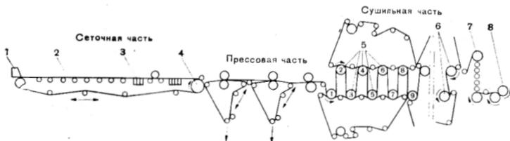
Рис. 5. Принципиальная схема бумагоделательной машины:
