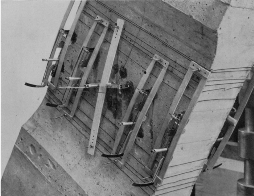
Abb. 16. Probekörper mit den angebrachten Meßinstrumenten.
