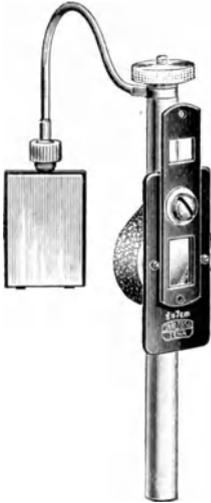
Der Silberspiegel am biegsamen Drahtbügel. Eine drehbare Blendenscheibe mit zwei rechteckigen Öffnungen vor der Bildlinse.
