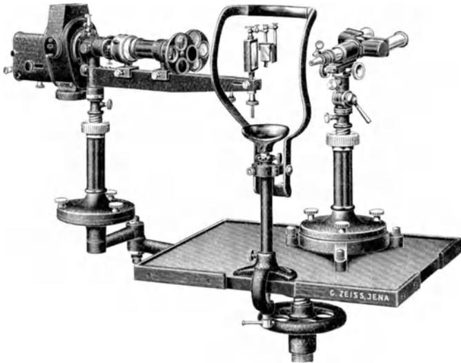
Eine Gerätschaft zur Polarisationsmikroskopie des Auges ähnlich wie in Fig. 20. Die neue Form der Bogenlampe. Unter der Bildlinse sieht man die Trieb- schraube zur Höhenverstellung nach H. ARRUGA.
