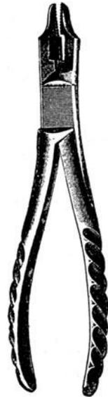
Abb. 369. Drahtzange zum Abschneiden, Fassen und Zusammen-drehen von Metall-drähten.
