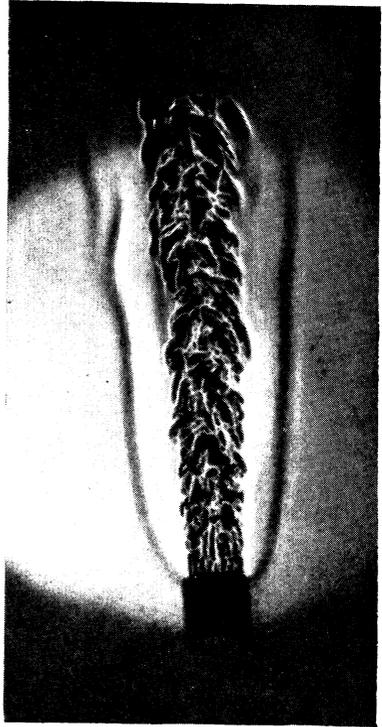
Фотография 17. Теневая фотография бутанового диффузионного пламени. Диаметр трубки ~10 мм. Число Рейнольдса, вычисленное по диаметру трубки, 8640.
