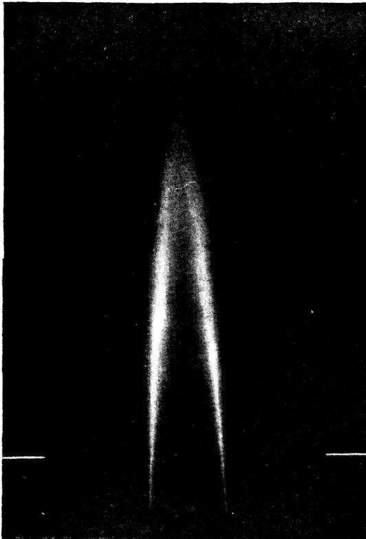
Фотография 10. Фотография пламени (негатив), применявшаяся для измерения скорости турбулентного горения.
