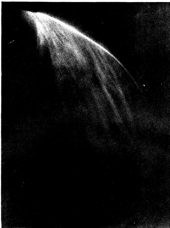
Фотография 21. Постепенное потухание заряда тротила. Обратите внимание на два участка, где скорость остается приблизительно постоянной: первый соответствует большой скорости (3800 м/сек), второй — низкой скорости (1800 м/сек) [21].
