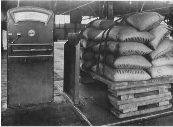
Abb. 63. Schaltneigungswaage im Schuppenbetrieb. Eßmann.
