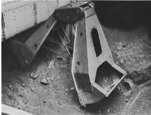
Abb. 76. Trimmgreifer. Demag.
