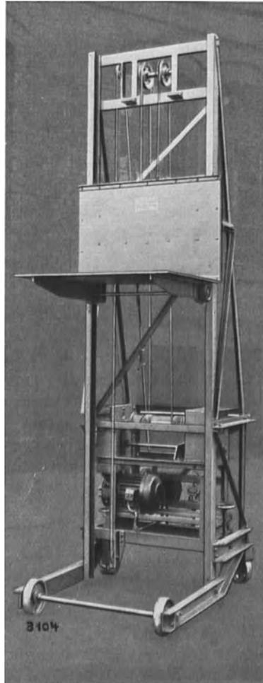
Abb. 49. Stapelaufzug. Mohr u. Federhaff.
