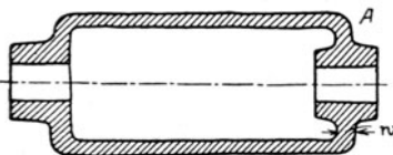
Abb. 124. Falsch. (Gefahr der Kernverlagerung!)
