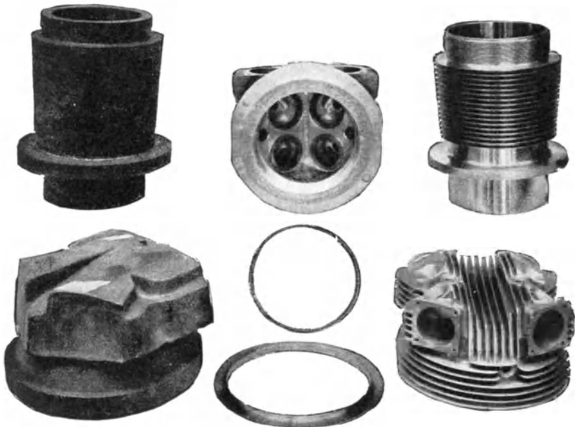
Abb. 256. Einzelteile des Zylinders für den Bristol Jupiter-Flugmotor 1929 vor und nach der Bearbeitung.
