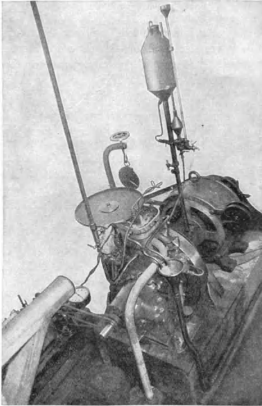
Abb. 45. Ansicht des neuen Versuchsmotors mit seitlich stehenden Ventilen. Der Motor ist mit empfindlichen Einrichtungen zum Messen des Verbrennungsdrucks bei jedem Kurbelwinkel und mit stroboskopisch gesteuerten Quarzfenstern zum Beobachten des Flammenfortschritts ausgestattet.
