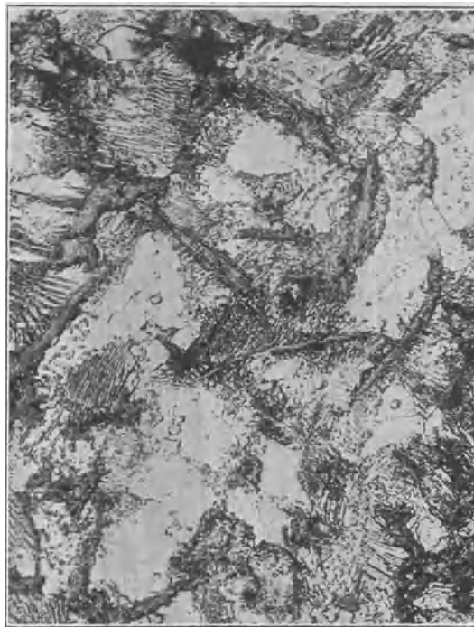
Abb. 15. Grauguß, zweimal getempert, Kern, geätzt (139).
