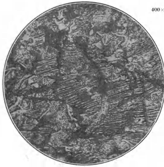
Abb. 14. Grauguß, einmal getempert, mittlere Ringzone, geätzt (139). 400×
