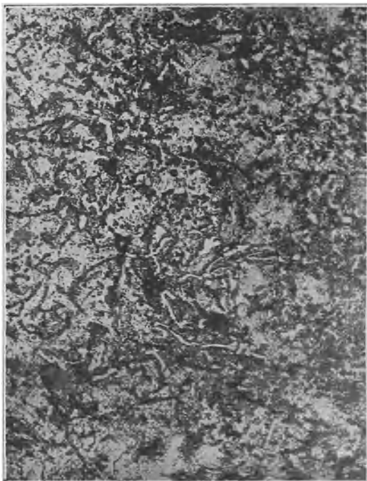
Abb. 16. Grauguß, zweimal getempert, Rand geätzt (139). 28×
