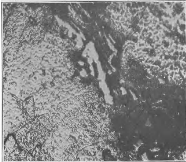
Abb. 38. Zementitkristalle im Temperguß (23).
