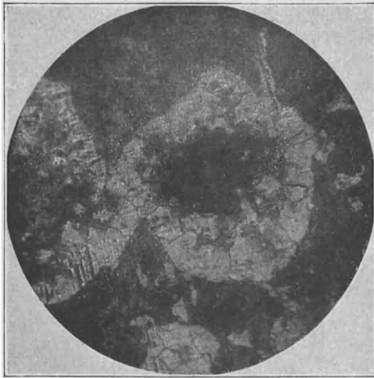
Abb. 27. Temperkohle bei Glühung II (87).
