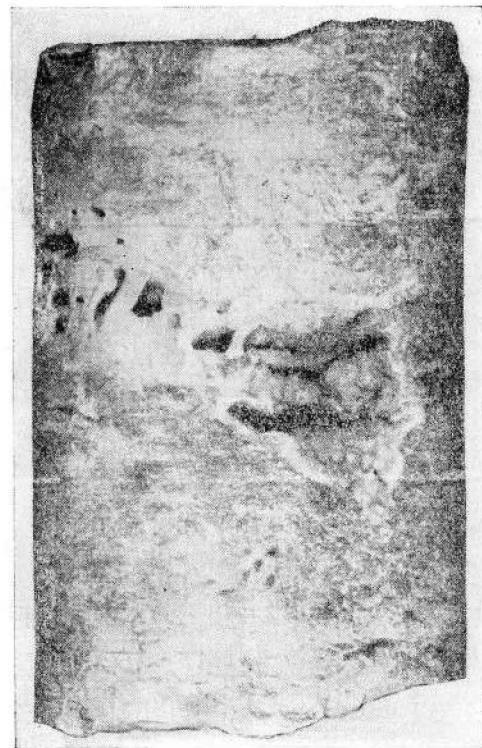
Рис. 2. Известняк биогермный, кавернозный (зона рифа). Каверны приурочены к колонии мшанок и инкрустированы кристаллическим кальцитом. Керн из Совхозной скв. 44, интервал глубины 1702,8—1705,8 м. 0,5 натуральной величины.
