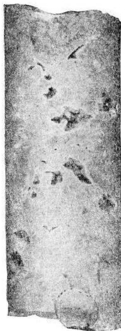
Рис. 1. Известняк биогермный кавернозный (зона рифа). Керн из Кумертауской скв. 41, интервал глубины 1846,5—1847,05 м. 0,5 натуральной величины.
