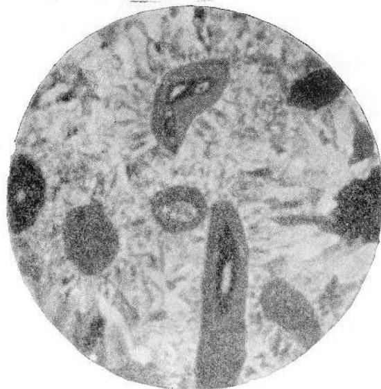
Рис. 1. Известняк биогермный кавернозный (зона рифа). Керн из Кумертауской скв. 41, интервал глубины 1846,5—1847,05 м. 0,5 натуральной величины.
