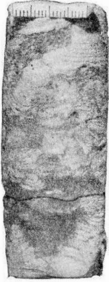
Рис. 10. Микростроение в крупнозернистом алевритовом, Айдаркинская скв. 75. Шлиф, ув. 8.
