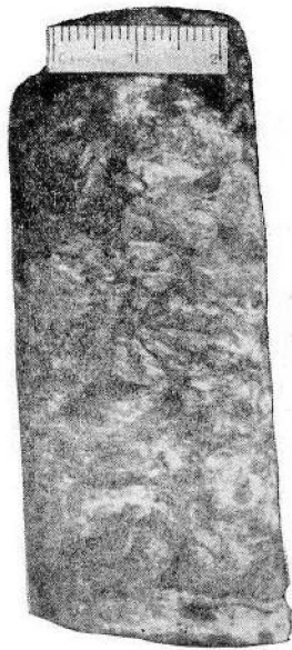
Рис. 18. Крупнозернистый алевролит с корневой системой. Бобриковский горизонт, Журавлевка-Степановка, скв. 445
