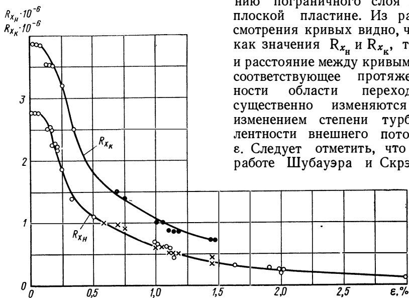
Рис. 20. Зависимость R_{x_H} и R_{x_k} в пограничном слое пластины от турбулентности потока: \times — данные [58]; \bullet — данные [62]; \circ — данные [235]
