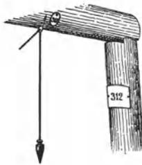
Abb. 9. Theodolitpunkt mit Stufe.
