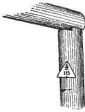
Abb. 8. Kompaßpunkt mit Stufe.
