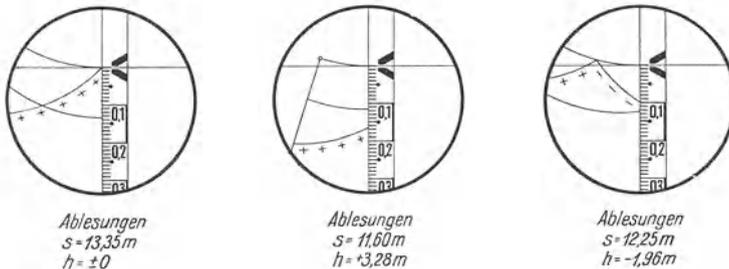
Abb. 112. Sehfelder des Hammer-Fennelschen Tachymeters.
