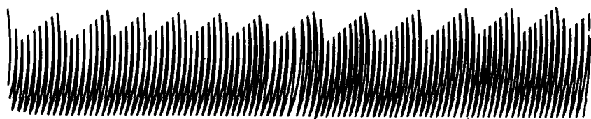
Рис. 48. Биения вблизи границы полосы синхронизации в режиме релаксационных автоколебаний
