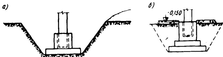
Рис. 5.1. Схема монтажа колонн
