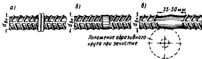
Рис. 10.1. Контактный стык стержневой арматуры для подкрановых балок
