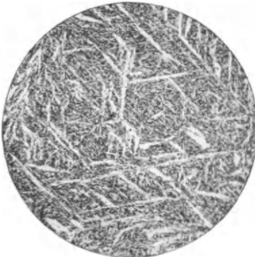
Abb. 27\*. Werkzeugstahl mit 1,54% Kohlenstoff bei 1100° C in Wasser abgeschreckt. Grober Martensit.
