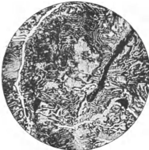
Abb. 63\*. Überhitzter Stahl mit groben Zementitadern. Die schwarze Furche gibt an, daß Zementit ausgebröckelt ist.
