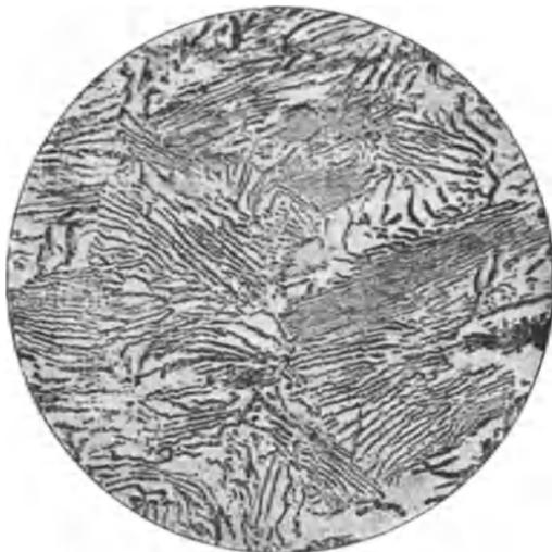
Abb. 16\*. Überhitzter eutektischer Kohlenstoffstahl mit heißer Natriumpikratlösung geätzt. Der Zementit des Perlits ist dunkel gefärbt.
