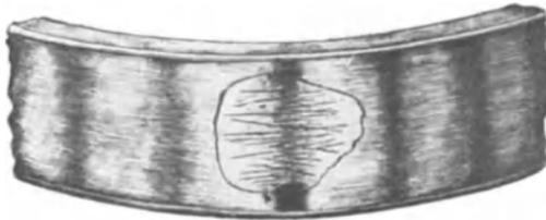
Abb. 79. Risse in der harten Außenseite eines Stahlringes.
