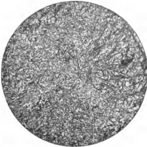
Abb. 28\*. Werkzeugstahl (Fräseifeile) mit 1,23% Kohlenstoff in Wasser abgeschreckt. Austenit zwischen den Martensitnadeln.
