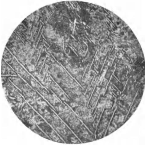
Abb. 13\*. Kohlenstoffstahl mit tafelförmigen Zementiteinlagerungen.
