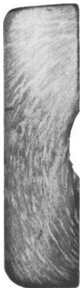
Abb. 162\*. Gefüge eines Schnittes aus Schnelldrehstahl von kurzer Lebensdauer.  $V = 5$ .
