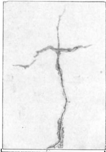
Abb. 114. Riß in der Lochwandung eines Feuerkastens aus Kesselblech. Nat. Größe.
