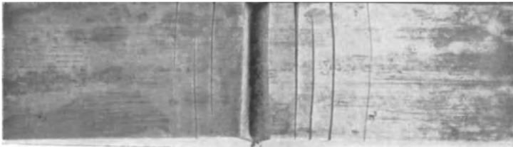
Abb. 145\*. Einsatzgehärteter Chromnickelstahl. Aufgerissene Außenschicht.
