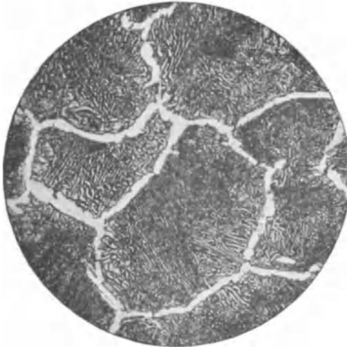
Abb. 122\*. Zementstahl mit 1,30% Kohlenstoff. Perlit und Zementit.
