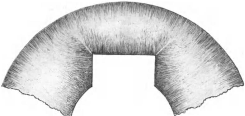
Abb. 81. Auftreten von Härtestreifungen an scharfen Ecken.
