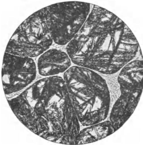
Abb. 34\*. Werkzeugstahl mit 1,54% Kohlenstoff bei 1350° C in Wasser abgeschreckt. Ledeburit im Austenit-Martensit.
