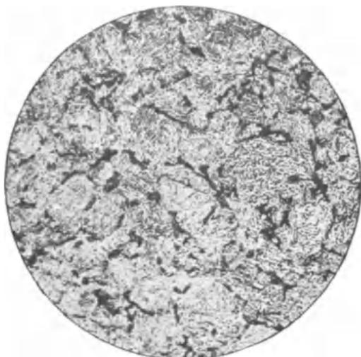
Abb. 25\*. Stahl mit 0,64% Kohlenstoff bei  $740^{\circ}\text{C}$  in Wasser abgeschreckt.
