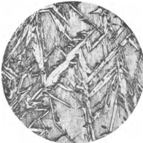
Abb. 29\*. Werkzeugstahl mit 1,57% Kohlenstoff bei 1350° C in Wasser von 5° C abgeschreckt. Grobe Martensitnadeln im Austenit.
