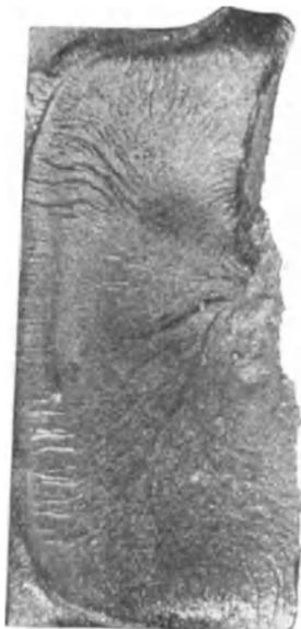
Abb. 107\*. Bruchfläche des Kaliberbolzens der Abb. 105 (etwa nat. Größe).
