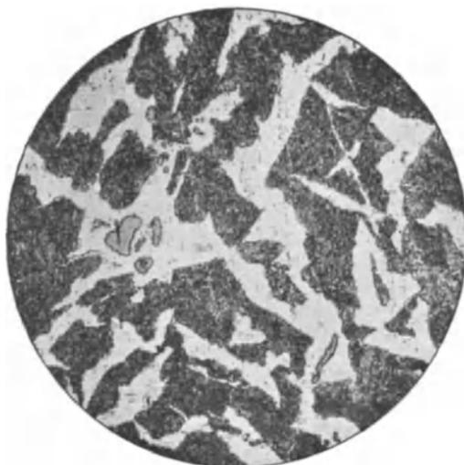
Abb. 45\*. Siemens-Martinstahl mit Schlackeneinschlüssen. Querschliff.
