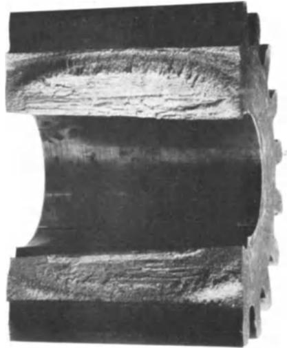
Abb. 110\*. Bruchfläche eines beim Härten geplatzenen Zahnrades (etwa  $\frac{1}{2}$  nat. Größe).
