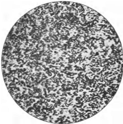
Abb. 91\*. Gehärteter Werkzeugstahl auf 670° C angelassen. Körniger Perlit.
