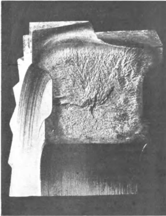
Abb. 150\*. Bruchgefüge eines überhitzten Fräasers aus Wolframstahl.
