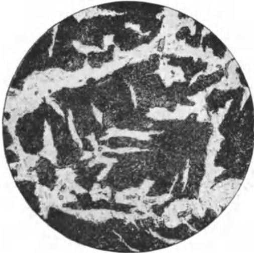
Abb. 133\*. Siemens-Martinstahl für im Einsatz zu härtende Zahnräder.
