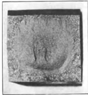
Abb. 127. Grobkörniger Bruch an Kanten und Ecken eines eingesetzten weichen Stahls.
