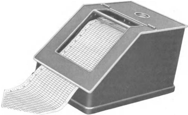
Abb. 201\*. Registrierendes Pyrometer (geschlossen).
