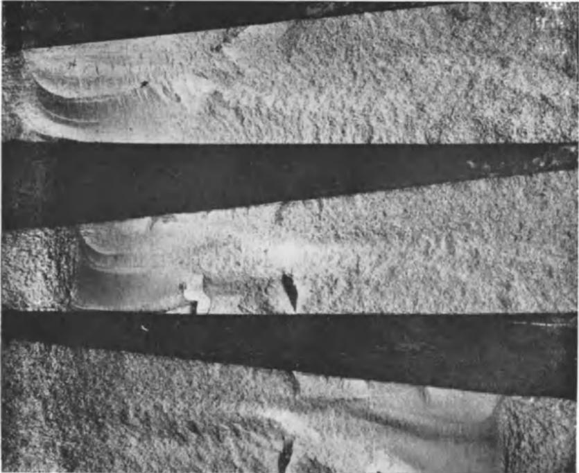
Abb. 74. Allings Härtingsprobe zur Bestimmung der richtigen Härtingstemperatur. Nat. Größe.
