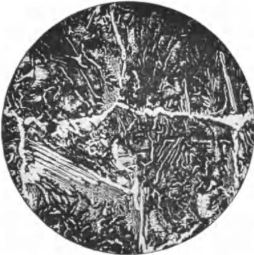
Abb. 71\*. Überhitzter Kohlenstoffstahl mit 1,54% Kohlenstoff. Grober Zementit und Perlit.
