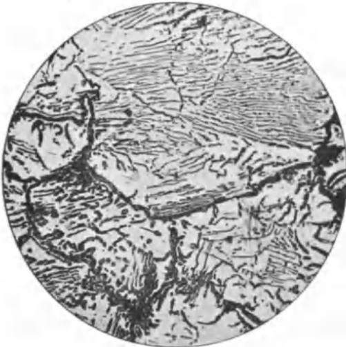
Abb. 72\*. Überhitzter Kohlenstoffstahl mit 1,68% Kohlenstoff, mit heißer Natriumpikratlösung geätzt. Grober Zementit.
