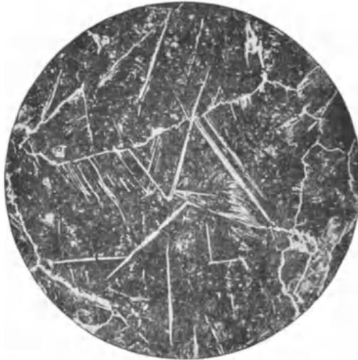
Abb. 14\*. Kohlenstoffstahl mit 1,54% Kohlenstoff. Perlit und Zementit.
