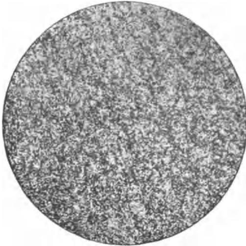
Abb. 21\*. Werkzeugstahl mit 1% Kohlenstoff bei 740° C in Wasser abgeschreckt. Feinkörniger Martensit.
