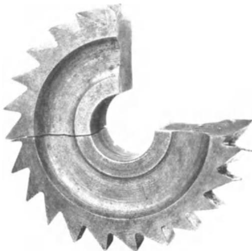
Abb. 151\*. Bruchteile eines überhitzten Fräsers aus Wolframstahl.
