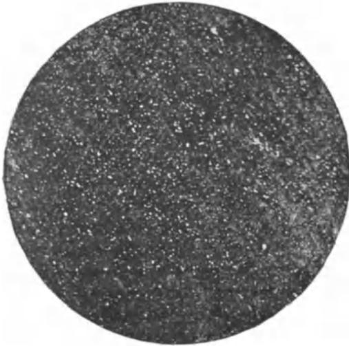
Abb. 160\*. Gefüge eines Schrappers aus Schnelldrehstahl.
