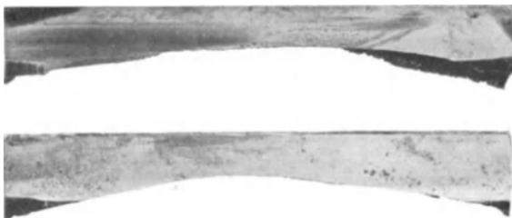
Abb. 96\*. Bogenförmig abgebrochene Zähne eines gehärteten Zahnrades.
