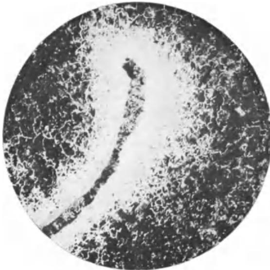
Abb. 50. Gußnaht in einem Stahlstabe.
