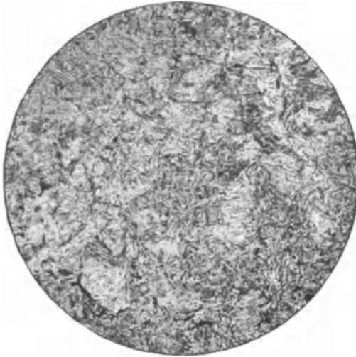
Abb. 26\*. Werkzeugstahl mit 0,89% Kohlenstoff bei 820° C in Wasser abgeschreckt. Martensit.
