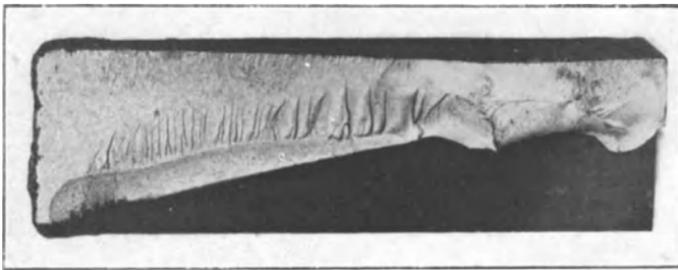
Abb. 117. Nach der Spitze zu überhitztes und regeneriertes Stahlstück mit der noch sichtbaren Wirkung des Überhitzens (links).
