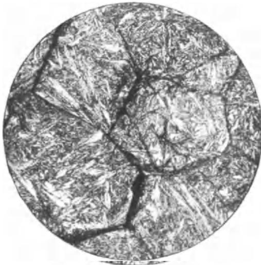
Abb. 32\*. Werkzeugstahl mit 1,54% Kohlenstoff bei 1280° C in Wasser abgeschreckt. Härterisse.
