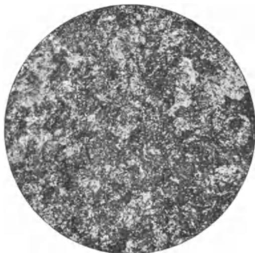
Abb. 10\*. Kohlenstoffstahl mit 0,89% Kohlenstoff. Perlit mit wenig Ferrit.
