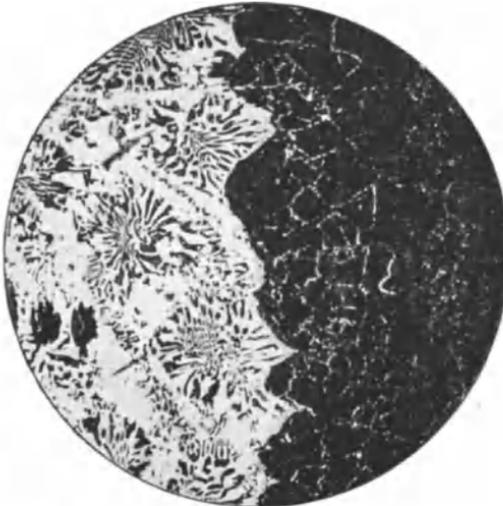
Abb. 141\*. Gefüge eines im Einsatz gehärteten Stahls nach der Aufnahme
