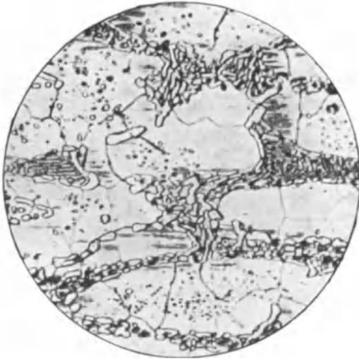
Abb. 172\*. Haarrisse in einem gehärteten Schnelldrehstahl.
