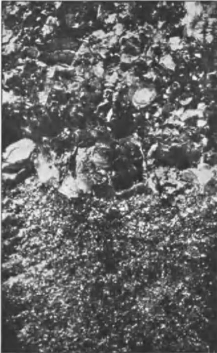
Abb. 56\*. Bruchaussehen einer Herdplatte aus einem Glühofen. Obere Schicht grob, untere Schicht feinkörnig.
