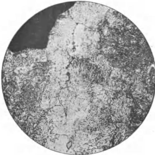
Abb. 47\*. Abgesplitterte Stelle am Zahnkopfe eines Zahnes von einem im Einsatz gehärteten Zahnrade. Ein Riß verläuft in Richtung der Schlackeneinschlüsse.
