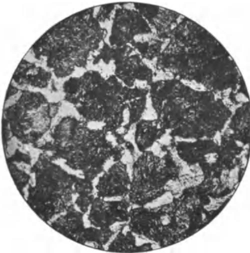
Abb. 68\*. Überhitzter Kohlenstoffstahl mit 0,55% Kohlenstoff.
