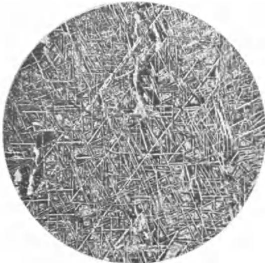
Abb. 124. Nadelförmiger Zementit in der Außenschicht eines im Einsatz gehärteten weichen Stahls.
