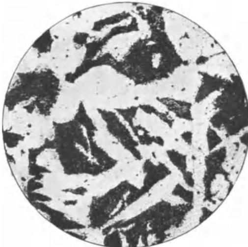
Abb. 22\*. Weicher Stahl mit 0,35% Kohlenstoff. Ferrit und Perlit.
