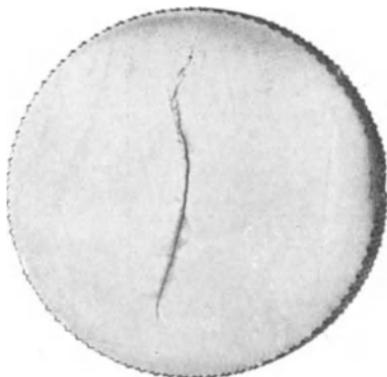
Abb. 108\*. Der im Kern gerissene Griff des Kaliberbolzens der Abb. 105 (wenig vergrößert)
