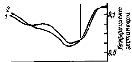
Рис. III.2. Определение изобестической точки Проционового ярко-оранжевого M = GS : 1 — активный краситель; 2 — гидролизованный краситель.
