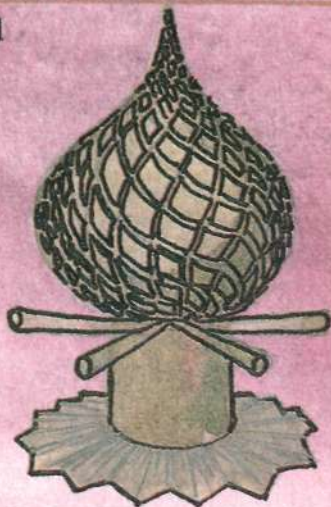
Рис. 151. Оформление работ по деревянному зодчеству: в — оклейка кровли купола; г — лемех; д — варианты оформления столбиков для крыльца
