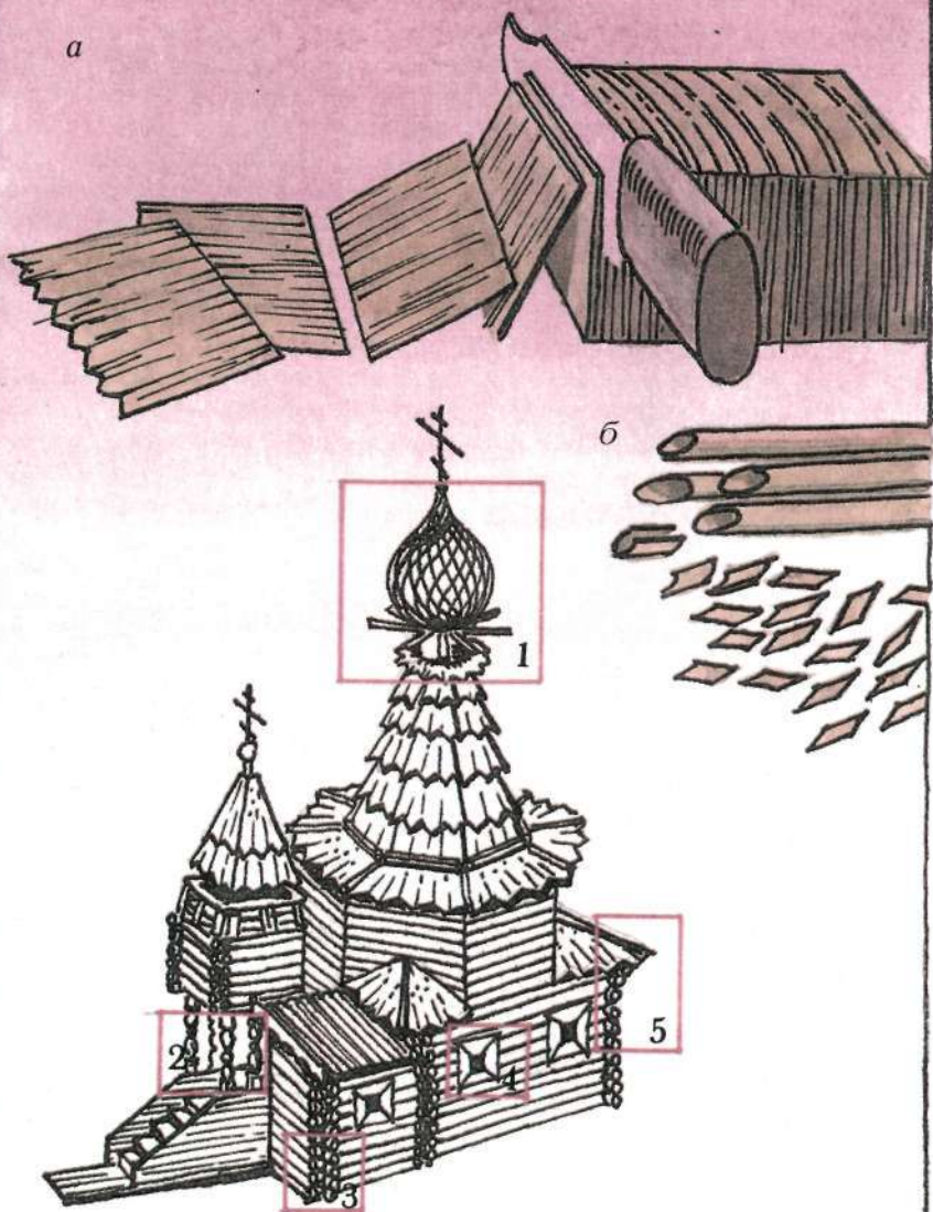
Рис. 151. Оформление работ по деревянному зодчеству: а — заготовка дубовой щепы для лемеха и других отделочных работ; б — заготовка пластинок для оклейки купола
