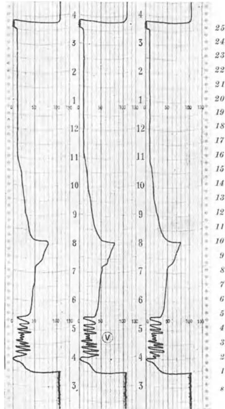
Abb. 379. Schreibstreifen eines Dreiphasen-Störungsschreibers (Netz Kurzschlußaufzeichnung) mit Schnellablauf.
