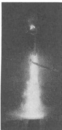
Abb. 256. Auspuffgase (Schaltfeuer) beim Ansprechen einer Hochspannungssicherung älterer Bauart durch Kurzschluß.
