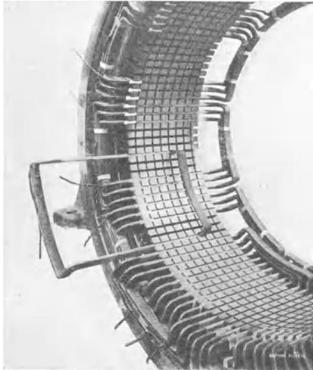
Abb. 135. Eingeschobene Spulenwicklung für 6 kV; halbgeschlossene Nuten.
