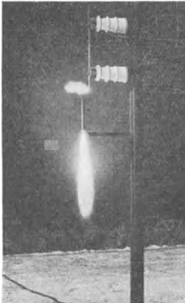
Abb. 361. Schaltfeuer beim Ansprechen des Löschrohrableiters.
