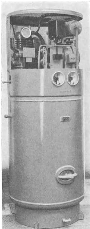
Abb. 283. Betriebsfertige Druckluft-erzeugungsanlage mit teilweise abgenommener Schutzhaube (SSW).
