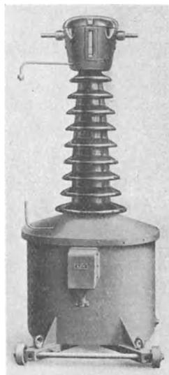
Abb. 396. Zusammengebauter Strom- und Spannungswandler mit Ölinsolation für Freiluft, Reihe 100, mit Ölstandsanzeiger und Schutzfunkenstrecke.
