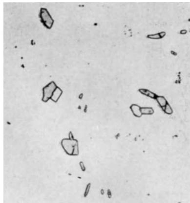
Abb. 135\*. 3,05%Cu, 1,31%Mg, Si, 0,12%Si. 16 Tage bei 500° homogenisiert, dann langsam auf 450° gekühlt (16 Tage) und dann abgeschreckt. Segregat von  $\text{CuAl}_2$  und der Al-Cu-Mg-Si-Verbindungen sind koaguliert. Kein  $\text{Mg}_2\text{Si}$ . (hell  $\text{Al}_2\text{Cu}$ ; Halbton Al-Cu-Mg-Si-Verbindung; Grundmasse  $\alpha$ .)
