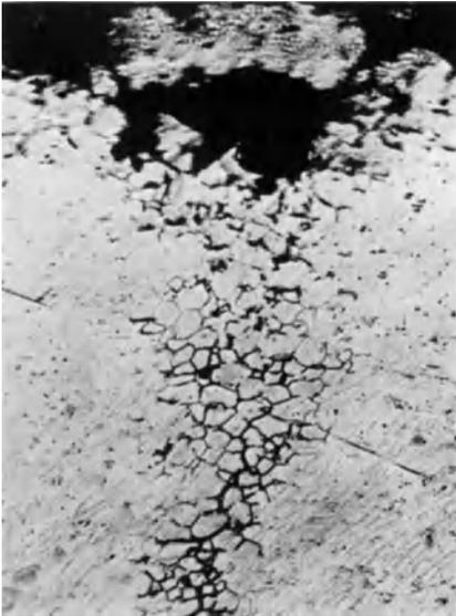
Abb. 195 a. Bildung einer fistelähnlichen Auflockerung von einer Blechseite zur anderen.  $V = 170$ ; ungeätzt.
