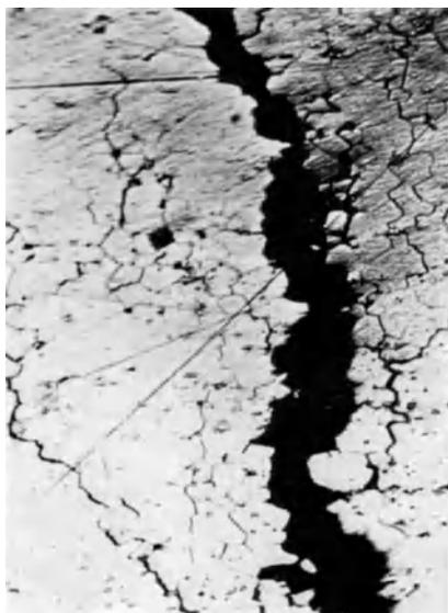
Abb. 195 b. Stehen Stellen nach Abb. 195 a unter Spannung, so reißt das Material plötzlich nach genügender Auflockerung des Gefüges.  $V = 170$ ; ungeätzt.
