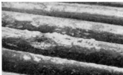
Abb. 193\*. Korrosion von Al-Draht durch aufgewalztes Kupfer.  $V=2,5$ ; ungeätzt.
