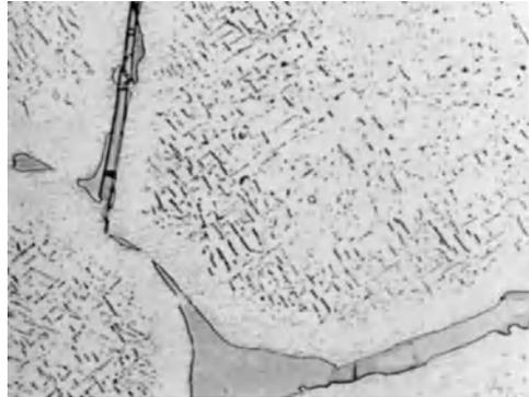
Abb. 88a. Langsam gekühlte Mischkristall-Legierung (4% Cu, 1,6% Si). Kaum zonig, in den Körnern zahlreiche Segregate von  $Al_2Cu$  und Si. Zwischen den Körnern überschüssiges  $Al_2Cu$  und Si (letzteres in Gestalt einer Al-Fe-Si-Verbindung).  $V = 500$ ; Ätzung: 7,5 ccm HF, 8 ccm  $HNO_3$  und 25 ccm HCl in 100 ccm Wasser, 3 Min.
