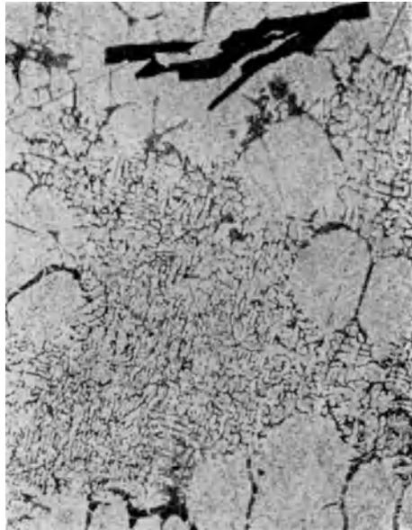
Abb. 109. Feld 2. 4 % Fe, 1 % Si. Primär  $\text{Al}_3\text{Fe}$  (dunkel). Sekundär  $\text{Al}_3\text{Fe} + \alpha$ . Tertiär Eutektikum  $\alpha + IV$  (Chinaschrift).  $V = 170$ ; Ätzung HF.
