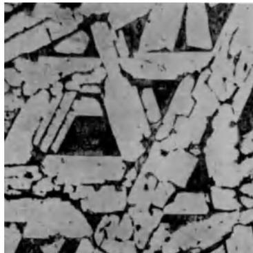
Abb. 41\*. 38,5% Ce. Primär Al,Ce (helle Balken). Sekundär Eutektikum Al—Al,Ce.  $V = 70$ ; Ätzung konzentrierte KOH 10—30 Sek.
