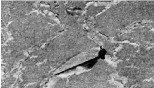
Abb. 180 c\*. Durch Überwalzen von Korngrenzenrissen verursachter Schiefer.  $V = 1$ ; ungeätzt.
