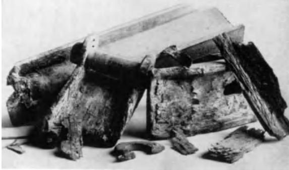
Abb. 194. Aufschieferung von Preßprofilen durch Korrosion.  $V = 0,5$ ; ungeätzt.
