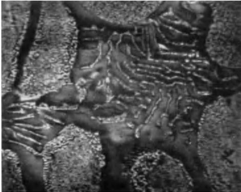
Abb. 84\*. Zusammensetzung entsprechend  $Al_2Zn_3$  (78,3% Zn), Gefüge s. Text.  $V = 1200$ ; Ätzung  $NaOH$  und  $HNO_3$ .
