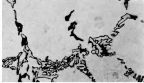
Abb. 138. Feld 15; 9,5% Cu, 3% Ni. Primär  $\alpha$  (Grundmasse). Sekundär Eutektikum  $\alpha + \text{Al}_3\text{Ni}$  (grau), nur stellenweise peritektischer Angriff unter Bildung von  $T$ , Eutektikum  $c + T$ . Tertiär  $\alpha + T + \text{Al}_2\text{Cu}$ .  $V=730$ ; Ätzung  $\text{HNO}_3$ .
