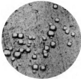
Abb. 2\*<sup>1</sup>. Al 99,8 %; würfelförmige Ätzfiguren.  $V = 620$ ; Ätzung 60 Sek.  $HNO_3 + HCl$ .
