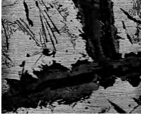
Abb. 103. Feld 5a. 6% Si, 6% Fe. Primär  $\text{Al}_3\text{Fe}$ , später umhüllt von IV. Sekundär Eutektikum  $\alpha + \text{IV}$ . Tertiär Eutektikum  $\alpha + \text{IV} + \text{Si}$ .  $V = 170$ ; Ätzung HF.
