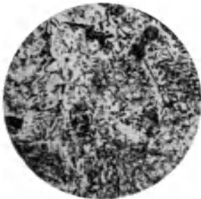
Abb. 42\*. 1,38% Be, gegossen, eutektisch.  $V = 100$ ; Ätzung HF + HNO<sub>3</sub>.
