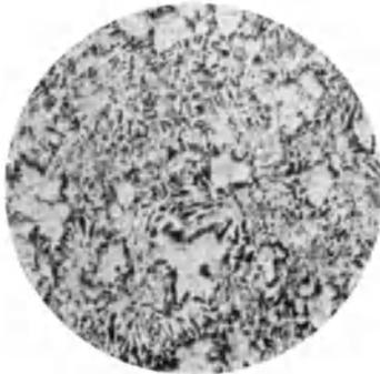
Abb. 63\*. 7,2% Li. Eutektikum Al +  $AlLi$ .  $V = 40$ ; ungeätzt, nur Luftfeinwirkung.
