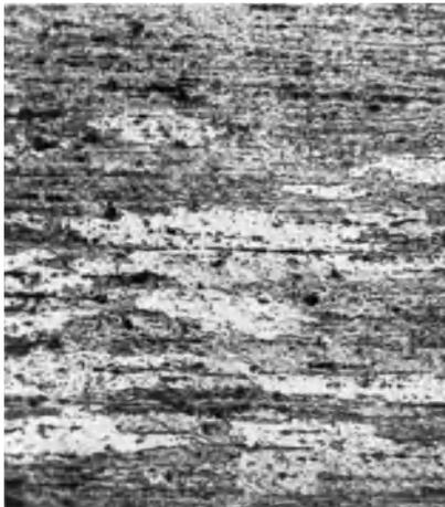
Abb. 33\*. Querschnitt durch ein Al-Blech, das 2 Std. 15 Min. bei 248° geglüht wurde. Nur teilweise rekristallisiert. Die neugebildeten Kristalle sind deutlich in der Walzrichtung orientiert.  $V = 90$ ; Ätzung  $HCl + HF$ . Blechrand nicht rekristallisiert.
