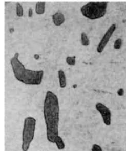
Abb. 64b\*. 12% Si. Langsam gekühlt. Durch Glühung bei  $550^\circ$  ist Si koaguliert.  $V = 160$ ; ungeätzt.
