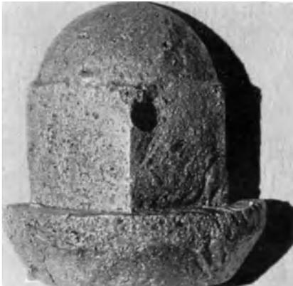
Abb. 128 a. Ansicht einer überhitzten Überwurfmutter aus Al—Cu—Si-Legierung.  $V = 2$ ; ungeätzt (nur in Sodälösung und nach Abspülung mit Wasser in Salpetersäure gebeizt, zur Erzielung eines klareren Bildes).
