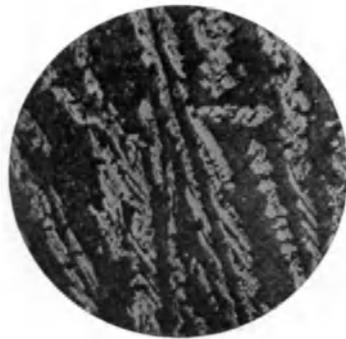
Abb. 44\*. 25% Ni. Primär  $Al_3Ni$  (hell). Sekundär Eutektikum  $Al-Al_3Ni$ .  $V = 24$ ; Ätzung  $FeCl_3$ .
