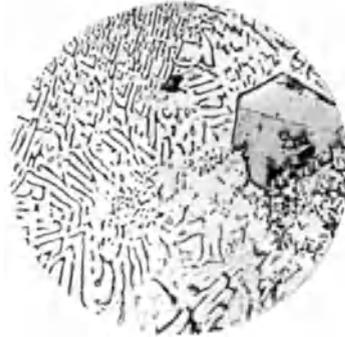
Abb. 97\*. Feld 7. 15%  $\text{Mg}$ , 8%  $\text{Si}$ . Primär  $\text{Mg}_2\text{Si}$ . Sekundär Eutektikum  $\text{Mg}_2\text{Si} + \alpha$ .  $V = 125$ ; ungeätzt.
