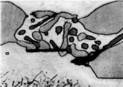
Abb. 125. Grenze der Felder 0 und 5. Überschüssiges  $\text{Al}_2\text{Cu}$ , Si (und  $\text{Al}-\text{Cu}-\text{Fe}$ -Verbindung).  $V = 1067$ ; Ätzung Lösung von  $25 \text{ cm}^3 \text{ HCl}$ ,  $8 \text{ cm}^3 \text{ HNO}_3$ ,  $7,5 \text{ cm}^3 \text{ HF}$  in Wasser (3 Min.).
