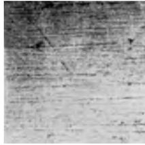
Abb. 81\*. 19% Zn. Rasch gekühlt, homogene Mischkristalle.  $V = 300$ ; Ätzung 10—15 Min. in  $\text{HNO}_3$ , spezifisches Gewicht 1,28.
