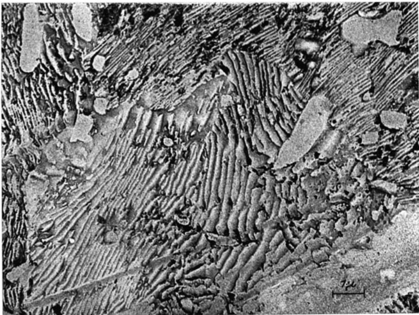
Abb. 27. Lackabdruck von feinstreifigem Perlit (kathodisch abgelöst). (Vergr.: 8000:1.)
