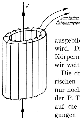
Abb. 25. Zum Nachweis des M. O. E. bei zirkulärem Magnetfeld nach K. Steiner (271).
