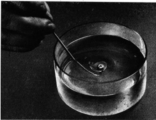
Abb. 20. Auffischen eines Abdruckfilmes. (Das Objektträgerplättchen liegt auf einer pfeifenförmigen Halteeinrichtung.)
