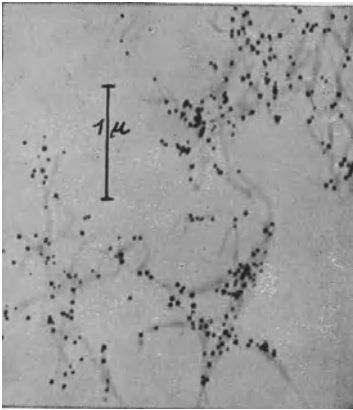
Abb. 167. Voluminöse Rotflockung durch Adsorption primärer Goldteilchen an Tabakmosaikvirusaggregate; Aufnahme mit dem „SIEMENS-Übermikroskop“; Abbildungsmaßstab 15 000:1 (Nach KAUSCHE u. RUSKA 464.)
