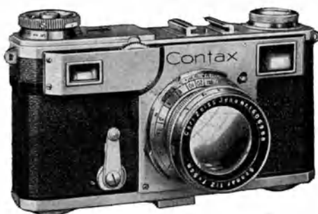
Abb. 43 a. Vorderansicht einer balgenlosen Kleinbildkamera mit ausziehbarem Objektivtubus, Schlitzverschluß und Schwenkkelten. Entfernungsmesserbasis zirka 90 mm (sog. Meßsucher). Leichtmetallgehäuse mit abnehmbarer Rückwand. Objektivstellung (Schneckenkengangfassung) gekuppelt mit dem Großbasistentfernungsmesser. Meßsucher und Entfernungsmesser sind einblicksgleich. (Modell Contax II der ZEISS-IKON A. G.)
