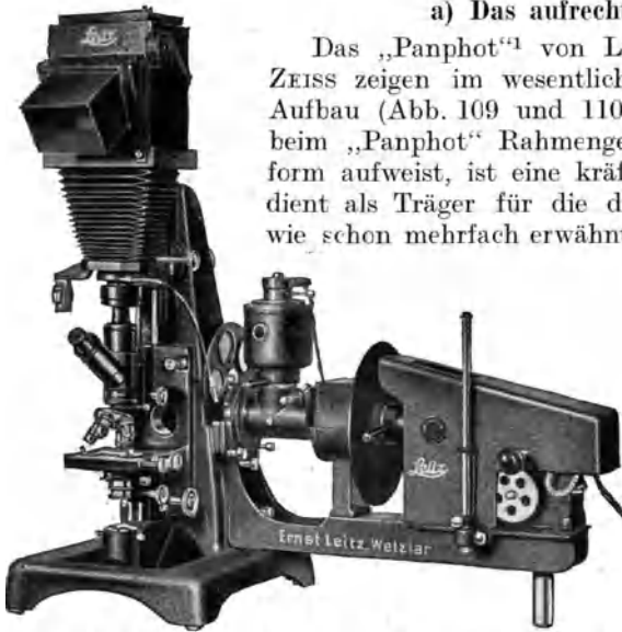
Abb. 109. Das LEITZsche Kameramikroskop „Panphot“ für Aufnahmen mit dem zusammengesetzten Mikroskop und durchfallendem Licht mit kombinierter Glühlampen-Bogenlampen-Beleuchtung (LEITZ).
