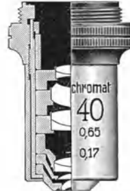
Abb. 46. ZEISSscher Planachromat 40/0,65, nat. Größe. (Aus der ZEISS-Druckschrift Mikro 367.)
