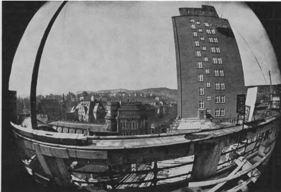
Abb. 99. Etwa 3\frac{1}{2} -fache Vergrößerung einer Contaxaufnahme bei Blende \frac{1}{8} mit einem Weitwinkelobjektiv nach Art der Linsenanlage 8/10 . Das Bildfeld entspricht einem Ausschnitt von etwa 165^\circ aus dem Dingraum.
