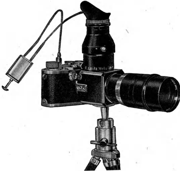
Abb. 33. Äußere Ansicht der Verbindung von Kleinbildkamera mit Spiegelreflexeinrichtung und langbrennweitigem Fernobjektiv Telyt 1 : 4,5, f = 200 mm (Bildwinkel \approx 12^\circ ). Sondergerät zur Scharfeinstellung und gleichzeitigen Festlegung des Bildausschnittes durch einen Mattscheibenaufsichtsucher. (E. LEITZ, Wetzlar.)
