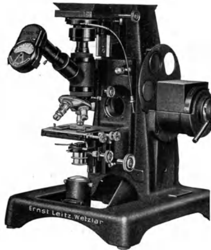
Abb. 157. Lichtelektrischer Belichtungsmesser „Tempiphot“ auf dem seitlichen Beobachtungstubus eines Kameramikroskops. (Aus der LEITZ-Druckschrift Mikrophoto, Nr. 7475 b.)
