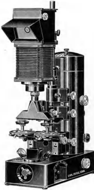
Abb. 123. Das ZEISSsche Ultraphot als Vergleichsmikroskop für durchfallendes Licht
