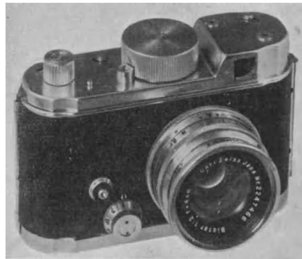
Abb. 60 Äußere Ansicht einer Kleinbildkamera mit Federwerk für den Filmtransport. Bildgröße 24 \times 24 mm. Optik Biotar 1 : 2, f = 40 mm. Bildwinkel \approx 50^\circ . (Tageslichtkassetten für max 50 Aufnahmen.)
