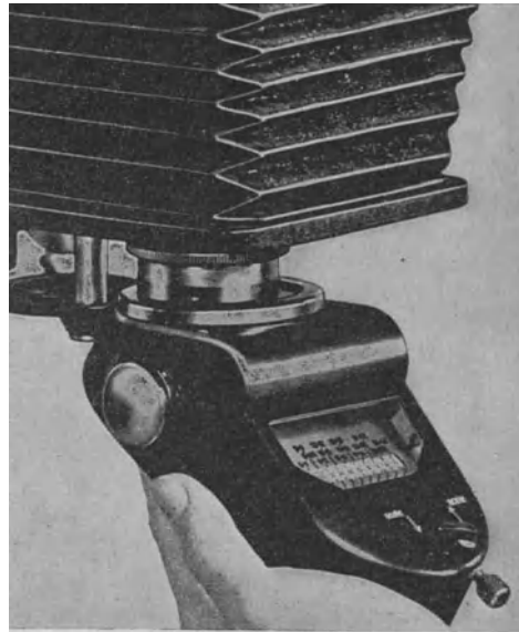
Abb. 36. Belichtungsmesser „Majus“ für den Vergröß erungsapparat. (GOSSEN, Erlangen.)
