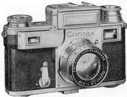
Abb. 53. Frontalansicht einer Kleinbildkamera mit eingebautem photoelektrischem Belichtungsmesser. Objektiv Sonnar 1·2, f = 50 mm, gekuppelt mit unsymmetrischem Großbasistentfernungsmesser. Metallschlitzverschluss (1 bis \frac{1}{1250} Sek.), Meßsucher (ZEISS-IKON A. G.). Die optisch wirksame Basis ist gleich dem Produkt aus der wirklichen Basis und der Vergrößerung bzw. Verkleinerung des Sucherbildes.
