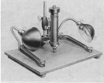
Abb. 148. Das ZEISS-IKON-Universalstativ auf Grundbrett mit Beleuchtungslampen, Mikrotar an einem Zwischenrohr und Lupe mit Gewichtsausgleichring. (Aus SEIFERT 281.)
