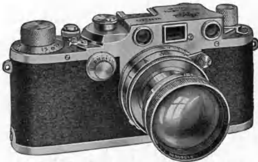
Abb. 58. Äußere Ansicht der Kleinbildkamera Leica Modell IIIc mit Spezialanastigmat „Summitar“ 1:2, f=50 mm. Der optische Sucher liegt zwischen den Lichteintrittsluken des Spiegelentfernungsmessers. Basis zirka 40 mm. Abstand der Einblicksöffnungen vom Sucher und Entfernungsmesser zirka 3 mm (vgl. Abb. 39). Zirka \frac{1}{2} der nat. Größe.
