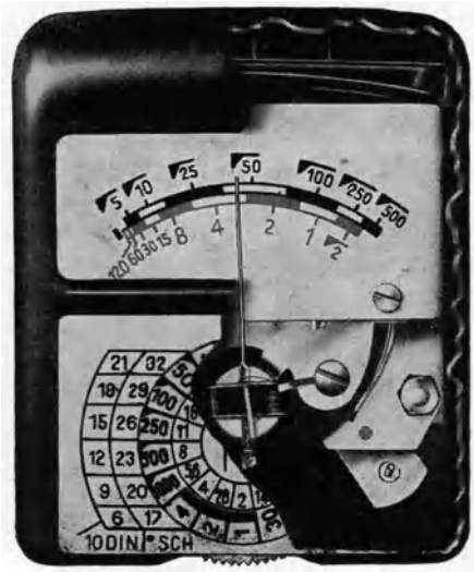
Abb. 15. Aufbau und Meßwerk eines Belichtungsmessers (Sixtus).
