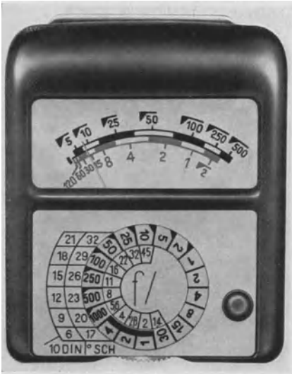
Abb. 17. Belichtungsmesser „Sixtus“. Die volle Kreisteilung der Rechenhilfe ist drehbar, die anderen Teilungen sind fest. Der Druckknopf rechts unten dient zum Umschalten des Meßbereichs auf die zweite Teilung des Zeigerausschlags.
