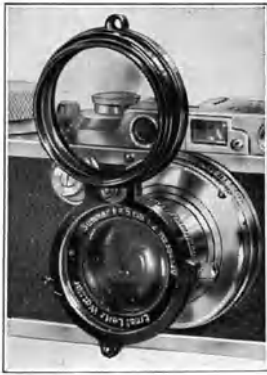
Abb. 25. Schwenkbares Polarisationsfilter der Firma LEITZ.
