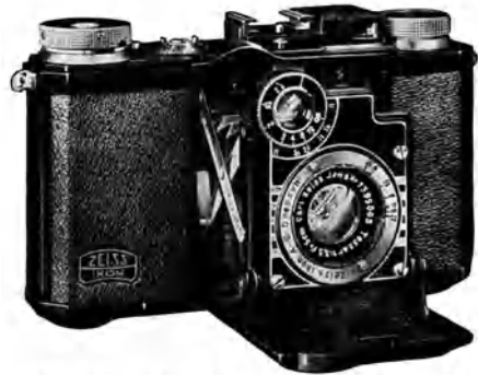
Abb. 44 a. Gebrauchsstellung einer Scherenspreizenkleinbildkamera mit Schlitzverschluß und Optik 1:3,5. Lederbalgen zwischen Objektivträger und Leichtmetallgehäuse. (Modell Super-Nettel der ZEISS-IKON A. G. mit Drehkeilentfernungsmesser.)
