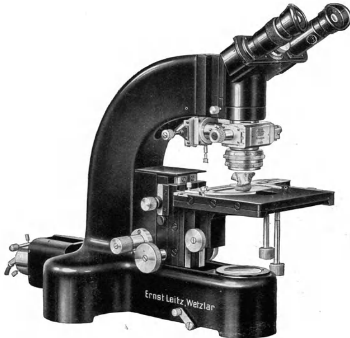
Abb. 97. Das große Mikroskop mit angebauter Lichtquelle „Ortholux“ von LEITZ, für durchfallendes Licht eingerichtet. (Aus JOHN 141.)
