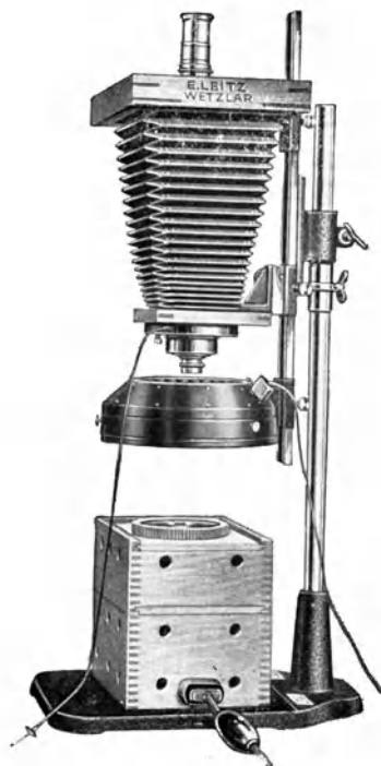
Abb. 39. LEITZsche „Makro-Ringbeleuchtung“ mit Leuchtkasten an einer Makro-Kamera. (Aus der LEITZ-Druckschrift Mikrophoto G, Nr. 7360 a)
