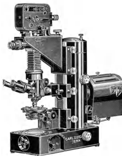
Abb. 113. Die Verwendung einer Schmalfilmkamera „Movikon 16“ am Kameramikroskop „Ultraphot“. (Aus MICHEL 208)
