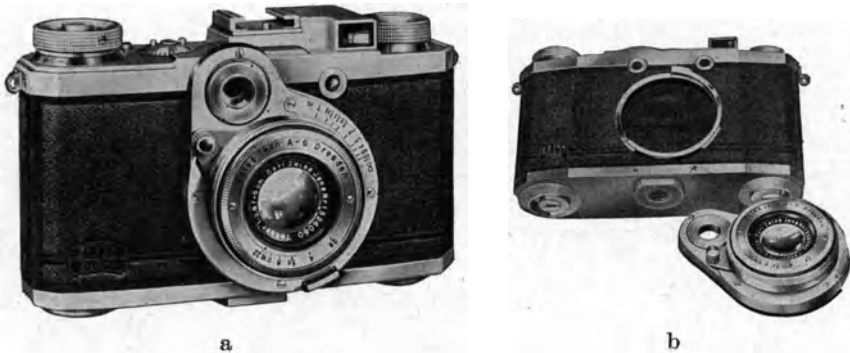
Abb. 45. Kleinbildkamera von starrer Bauart mit Drehkeilentfernungsmesser (nach BOSCOVICH) und Auswechselloptik. Basis und Drehkeile sind räumlich getrennt. Basis im Gehäuse. Normalobjektive: Tessare 1:3,5 und 1:2,8, f=50 mm. Auswechsellobjektiv: Triotar 1:5,6, f=105 mm. (Modell „Nettax“ der ZEISS-IKON A. G.) a Kamera in Gebrauchsstellung, b Objektiv mit Drehkeilsystem zwecks Auswechslung herabgenommen. Die Drehkeile bilden mit der Objektivfassung ein geschlossenes Aggregat.
