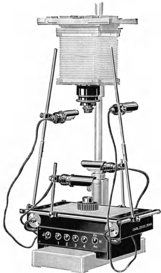
Abb. 43. Der ZEISSsche „Makrotisch“ an einer Vertikal-kamera. (Aus der ZEISS-Druckschrift Mikro 518.)
