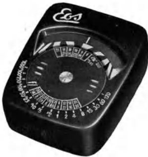
Abb. 20. Belichtungsmesser „Eos“ (Metrawatt). Die Empfindlichkeit wird über die Kanalskala auf den Zeiger eingestellt, alle zugehörigen Blenden und Belichtungszeiten stehen einander gegenüber.
