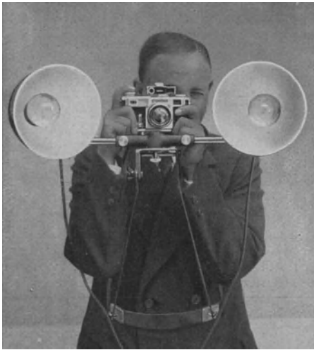
Abb 144 Das Bruststativ von ZEISS-IKON mit zwei Beleuchtungslampen und „Contax II“ mit „Contameter“. (AUS JACOBI 131.)
