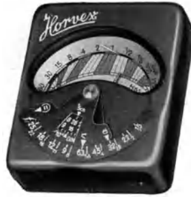
Abb. 18. Belichtungsmesser „Horvex H 60“. Der drehbare Teil wird mit einer der drei Marken, je nach dem Meßbereich, auf die Blende eingestellt und nimmt die mit einer Kanalskala mit dem Zeigerausschlag verbundene Belichtungszeitteilung mit. Lichtwähler (vgl. Abb. 14 und 16)
