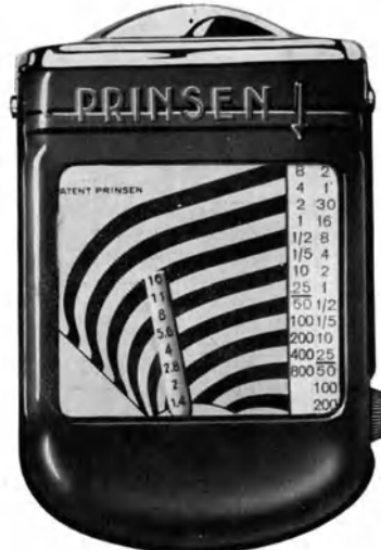
Abb. 21. Belichtungsmesser „Prinsen“. Zeiger trägt die Blendenteilung und ist durch ein festes Leitlinienfeld mit der nach der Schichtempfindlichkeit verschiebbaren Zeitskala verbunden. Zwei Zeitteilungen für die beiden Meßbereiche.
