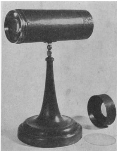
Abb. 1. Erste Kleinbildkamera für Papierbilder. (STEINHEIL und KOBELL, Baujahr 1839, Photographie auf Chlorsilberpapier.)
