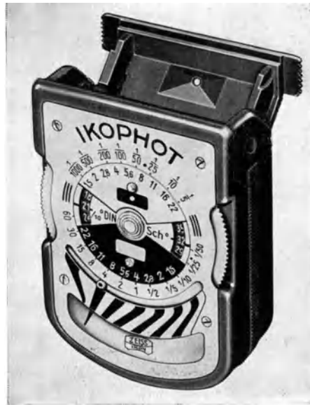
Abb. 26. Belichtungsmesser „Ikophot“. Der Knopf im Kreisbogenschaltz wird über die Kanalskala auf den Zeiger eingestellt und verdreht die innere Kreis-skala. Alle Blenden und Zeiten stehen einander gegenüber. Die Teilungen sind wegen der beiden durch Klappe vor dem Photoelement schaltbaren Meßbereiche doppelt vorhanden.
