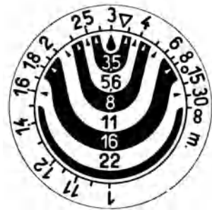
Abb 27. Gleichachsige Anordnung einer Tiefenschärfenanzeigevorrichtung für Entfernungen von \infty bis 1 m bei Abblendung auf 1:3,5 bis 1:22. (VOIGTLANDER A. G.)
