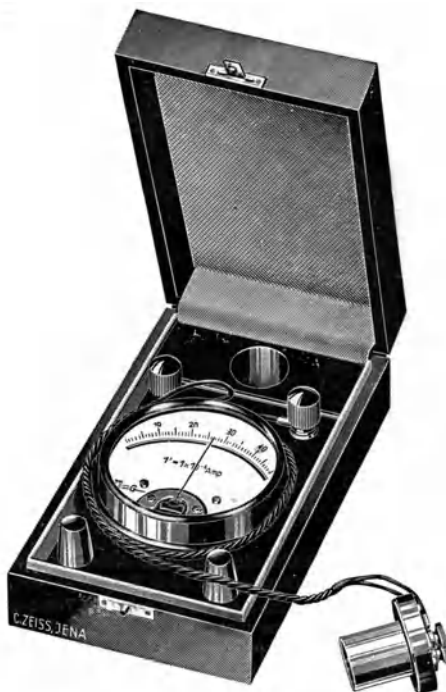
Abb. 159. Okularphotozelle mit Meßinstrument von ZEISS. (Aus MICHEL 208.)
