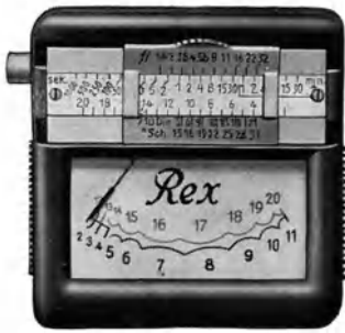
Abb. 22 Belichtungsmesser „Rex“. Rechenschieber mit Strichteilung als Rechenhilfe. Zwei Teilungen für den Zeigerausschlag, den beiden durch Widerstand schaltbaren Meßbereichen entsprechend. Kreisförmiges Photoelement ohne besonderen Lichtwähler in Anordnung nach Abb. 13.
