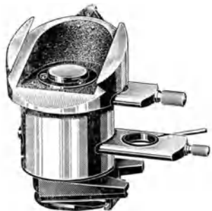
Abb. 41. Schlittenanalysatoransatz mit Kalkspatanalysator.
