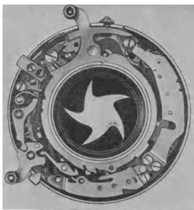
Abb. 64 a. Innere Ansicht des Compur-Rapid-Verschlusses 0 bei abgenommener Deckplatte. (Eingebautes Vorlaufwerk für Selbstaufnahmen.)
