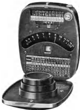
Abb. 25. Belichtungsmesser „Elektro-Bewi“. Hilfs-wert des Zeigerausschlags wird auf Schichtemp-findlichkeit eingestellt, alle zusammengehörigen Blenden und Zeiten stehen einander gegenüber. Teleskoprohrstützen als Lichtwähler. Die recht-eckige Öffnung dient dem Lichteintritt des opti-schen Belichtungsmessers mit Einblicksöffnung von der Rückseite.
