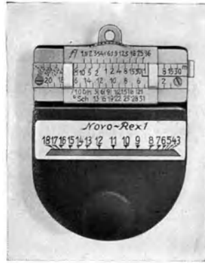
Abb. 23 Belichtungsmesser „Novo-Rex“. Ähnlich wie Rex, jedoch nur ein Meßbereich und rechteckiges Photoelement.
