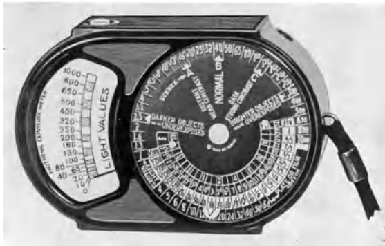
Abb. 32. Belichtungsmesser „617-2“ von WESTON (USA) (nach SEWIG).
