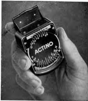
Abb. 24. Belichtungsmesser „Actino“. Zwei Ausführungen Blende (A) oder Belichtungszeit (B) wird auf Schichtempfindlichkeit gestellt, der zweite dieser Werte wird auf Hilfskala abgelesen, die mit dem Zeigerausschlag gleich beziffert ist.
