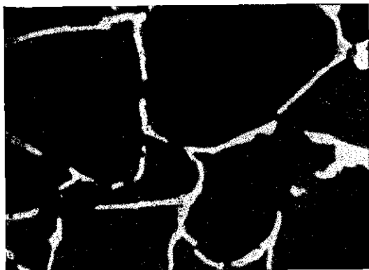
Рис. 155. Разрез брикета, изготовленного горячим прессованием из частиц \text{SiO}_2 , покрытых молибденом. \times 250 (Клейн и Вульф)
