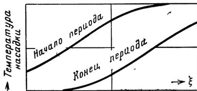
Рис. 161. Точечная симметрия распределения температуры в насадке в начале и в конце одного периода при  $\Lambda=\Lambda'$  и  $\Pi=\Pi'$ .
