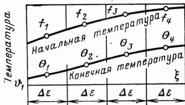
Рис. 177. Деление регенератора на участки одинаковой ширины  $\Delta \varepsilon$  со средними температурами  $f_1, f_2 \dots$  и  $\theta_1, \theta_2 \dots$  и т. д.
