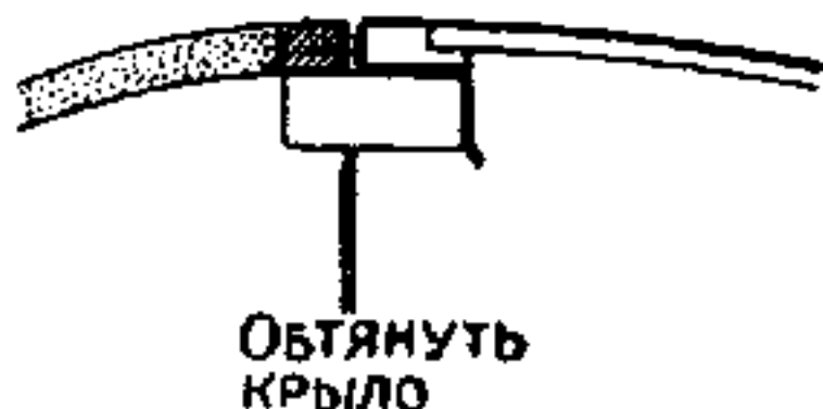
Рис. 7.10. Последовательность операций по закреплению мягкой обшивки.
