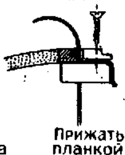
Рис. 7.10. Последовательность операций по закреплению мягкой обшивки.
