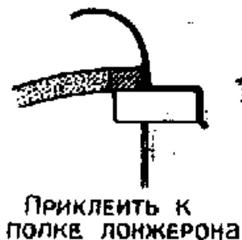
Рис. 7.10. Последовательность операций по закреплению мягкой обшивки.
