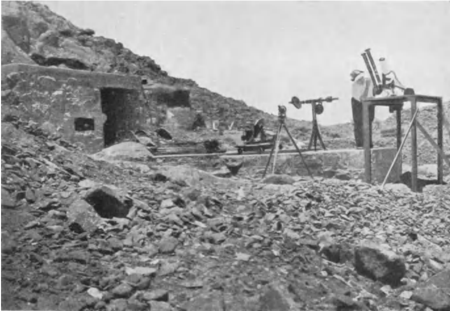
Abb. 19. Teilbild der südafrikanischen Station des Smithsonian-Observatoriums auf dem Berge Brukkaros (1600 m). Der Beobachter bedient (im Bilde rechts) die beiden Pyrheliometer und das auf derselben Montierung angebrachte Pyranometer. [Smithson Ann 5 (1932).]
