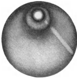
Abb. 83. Das extrafokale Sternbild eines Parabolspiegels mit Markierung der Mitte durch eine Blende.
