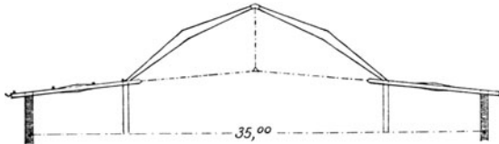
Abb. 12. Binder einer dreischiffigen Halle (mit Hauptschiff-Binder nach Abb. 11).
