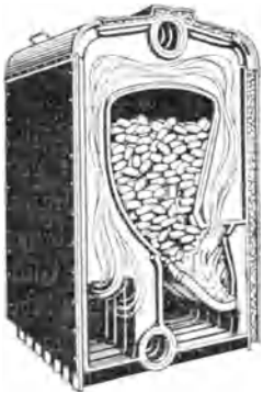
Fig. 154. Kollarkeffel der Buderusschen Eisenwerke, Weßlar, mit Braunkohlenbrikettfeuerung mit unterem Abbrand.
