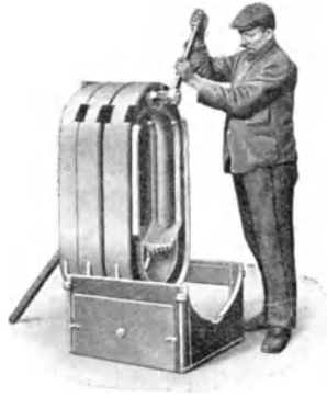
Fig. 150. Zusammenbau des Strebelkessels.
