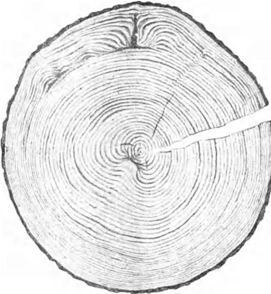
Abb. 48. Querschnitts Scheibe einer Tanne mit überwallten Verletzungen.
