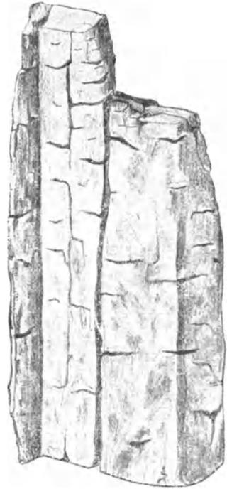
Abb. 89. Stück eines Türstockes durch den echten Hausschwamm *Merulius lacrymans* vollständig zerstört.
