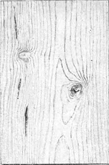
Abb. 38. Stück eines Fichtenbrettes mit eingewachsenen Ästen und Harzgalen.
