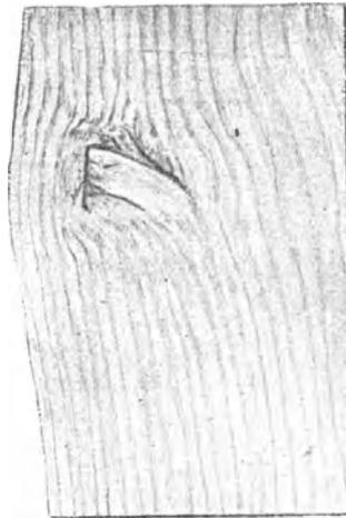
Abb. 41. Stück eines Lindenbrettes mit abgesägtem, gesund überwälltem Ast.
