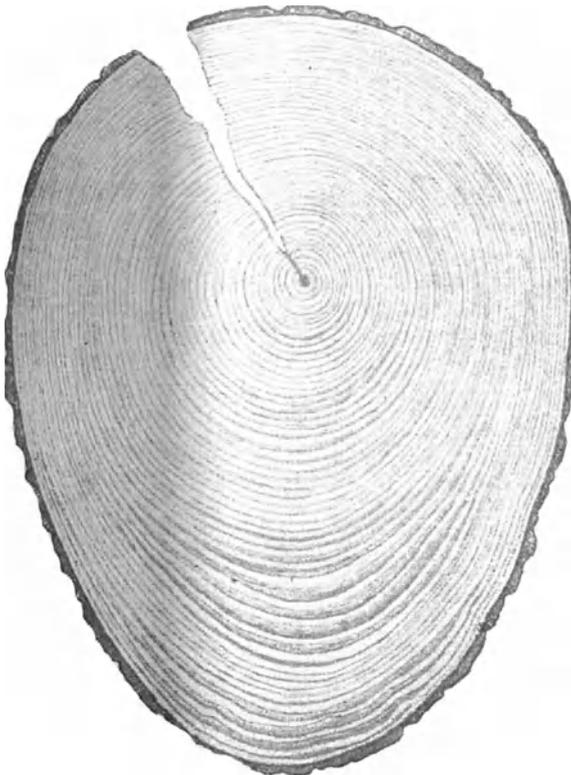
Abb. 34. Querschnittsbeile von einem Fichtenstamm mit exzentrischem Wuchs, Rothholzbildung und Trockenriß.
