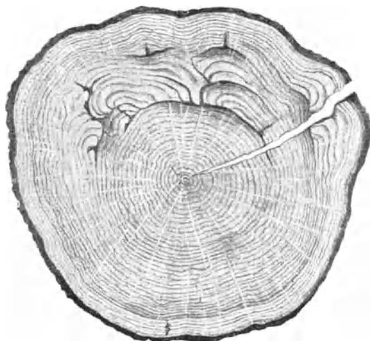
Abb. 57. Blitzspuren (überwallt) an einer Eichenstammscheibe.
