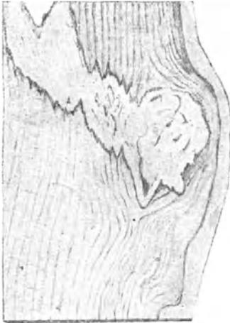
Abb. 60. Vom unechten Feuerschwamm (*Polyporus igniarius*) zerstörtes Eichenstück. Die Infektion erfolgte durch eine Astwunde.
