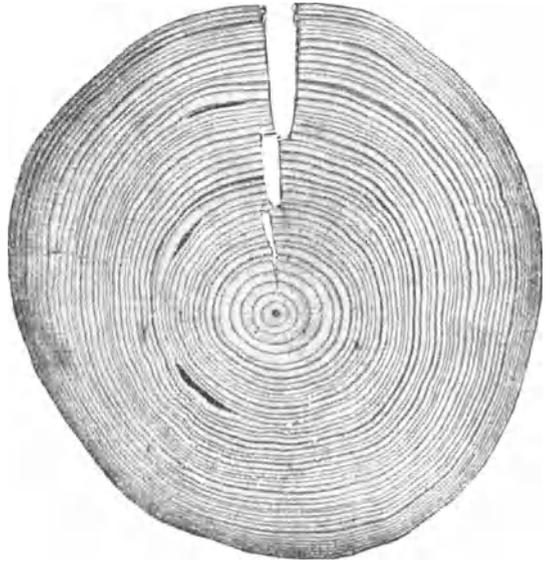
Abb. 10. Querschnitt aus dem Stammholze der Fichte mit Trockenriß (Luftriß) und Harzgallen.
