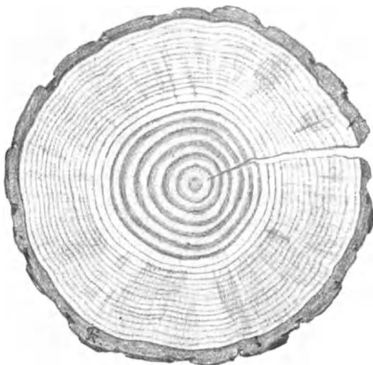
Abb. 88. Kiefernstammscheibe, an welcher das Splintholz durch den Blaufäulepilz — *Ceratostomella pilifera* — bläulichgefärbt erscheint.
