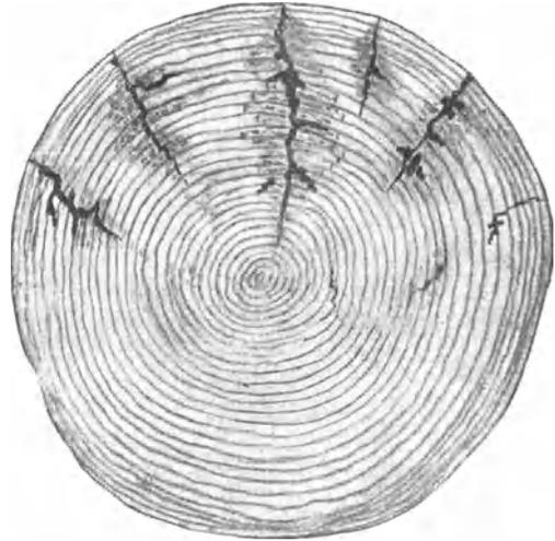
Abb. 69. Im Stand vollkommengesunde Fichte, mit Faulstellen im Innern des Holzes, durch Pilzkeime hervorgerufen, welche durch Sonnenrisse in den Holzkörper gelangt, wobei das Holz nach dem Flößen nicht rasch genug geschnitten wurde.
