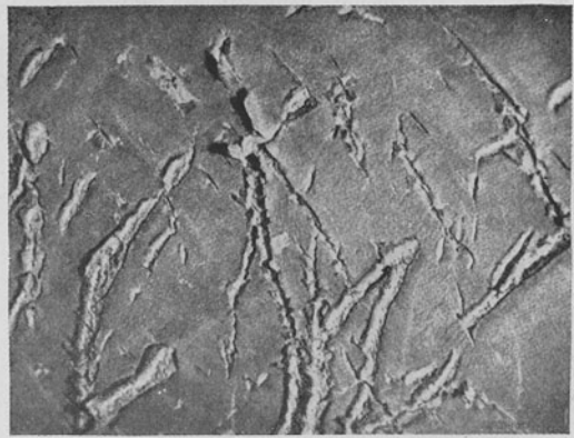
Abb. 392. Offene Dornheckenrisse auf Brandsohlleder ( \frac{2}{3} nat. Gr.) [F. Stather (5)].
