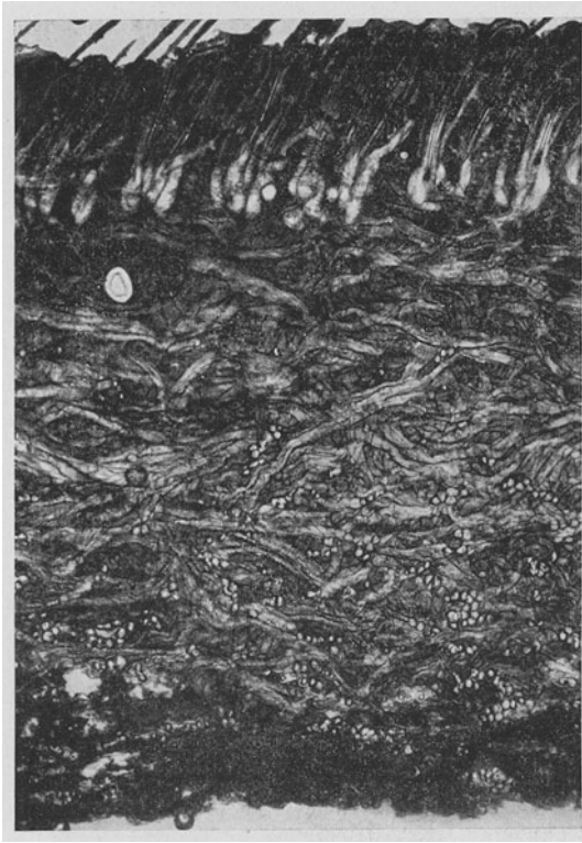
Abb. 165. Gefrierschnitt durch eine unpräparierte, fettreiche Rindshaut, Bauchseite mit zahlreichen Fettkörpereinschlüssen (Vergr. 11,25mal).
