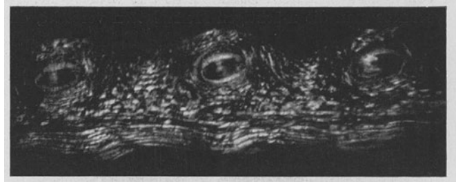
Abb. 194. Schnitt durch Leder der Javaeidechse mit Hautverknöcherungen, die Schuppen sind quer geschnitten (Vergr. 14,4mal).
