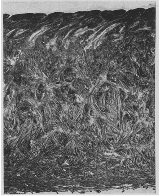
Abb. 150. Faserverlauf im Kernstück der Rindshaut, Schnittebene parallel der Haarrichtung (Sohlleder) (Vergr. 11,25mal).
