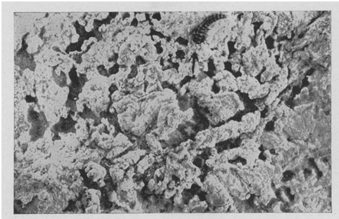
Abb. 436. Durch Käfer von der Fleischseite aus zerstörte gesalzene Rindshaut [F. O'Flaherty und W. T. Roddy (2)].
