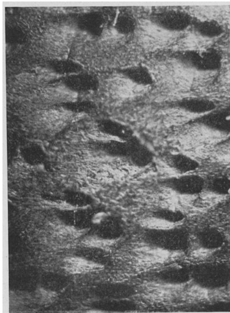
Abb. 92. Verletzung der Narbenmembran an der Haartrichterwand von fäulnisbeschädigtem Leder (Vergr. 160mal).
