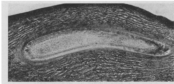
Abb. 194. Schnitt durch Leder der Javaeidechse mit Hautverknöcherungen, die Schuppen sind quer geschnitten (Vergr. 14,4mal).
