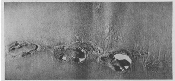
Abb. 396. Fahlleider mit Narbenverletzung der Haut durch Stallkette [F. Stather (5)].
