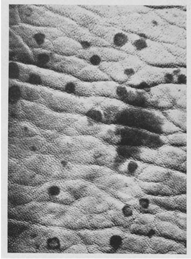
Abb. 371. Fleckenbildung durch Dematiumpilze auf feuchtem Schafleder ( \frac{1}{5} natürl. Größe) [W. Hausam (6)].
