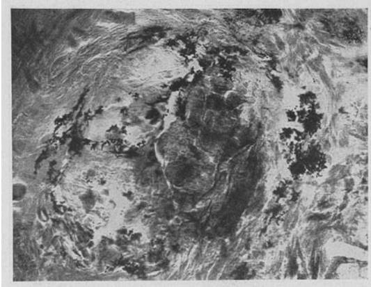
Abb. 333. Schollen veränderten Gewebes, von Pilzsporen haufenweise umgeben. Flächenschnitt durch sog. Haarpilzstippe (Vergr. 120mal) [M. Bergmann (1)].
