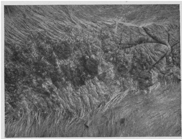
Abb. 434. Nematodenschaden auf gesalzener Rindshaut [L. S. Stuart und R. W. Frey (3)].
