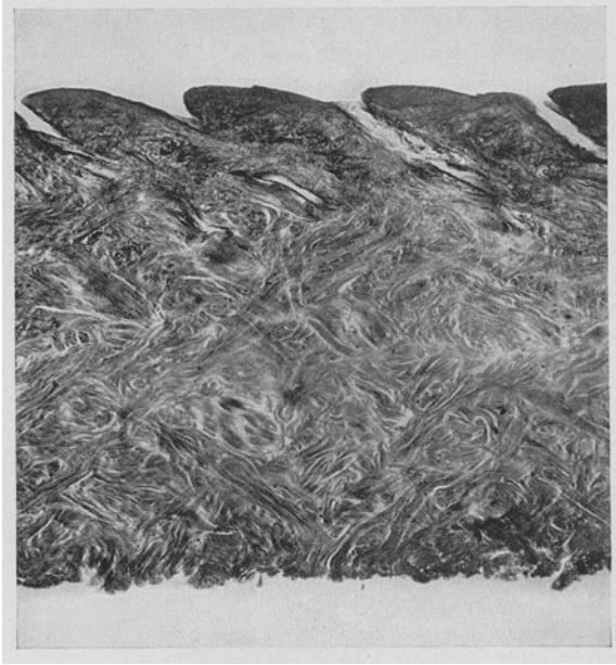
Abb. 224. Querschnitt durch Seehundleder, pflanzlich gegerbt (Vergr. 11,25mal).
