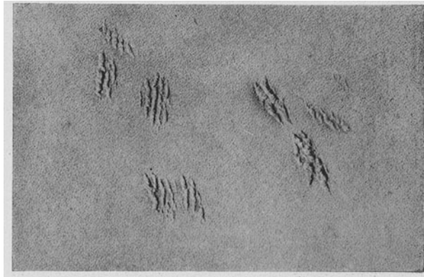
Abb. 398. Ausstoßschaden auf der Narbenseite eines unzugereichteten Boxkalbleders ( \frac{2}{3} nat. Gr.) [F. Stather (5)].
