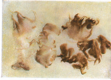
Abb. 348. Links: unverfärbte Wollprobe von einem mit Petrolsalz gesalzenen Schaffell stammend. Die Wolle ist ungewaschen; dunkel gefärbt erscheinende Randteile = Schmutz. Rechts: rotbraunverfärbte Wollprobe von einem mit Naphthalinsodasalz gesalzenen Schaffell stammend. Wollhaare durchweg rotbraun verfärbt (etwa \frac{4}{10} nat. Gr.) (W. Hausam, T. Schindler und E. Liebscher).
