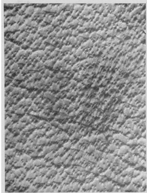
Abb. 91. Faulstelle, die zu vermindertem Glanz der Oberfläche Anlaß gibt (Vergr. 28mal).
