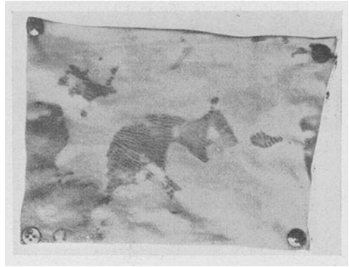
Abb. 444. Salzflecken auf dem Narben einer Kalbsblöße ( \frac{1}{3} nat. Gr.) (F. Stather und G. Schuck).
