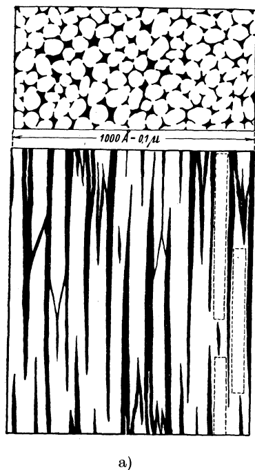
Abb. 254. Mizellarstruktur von gewachsenen Faserstoffen (Bastfasern) [nach A. Frey-Wyßling (2)].
