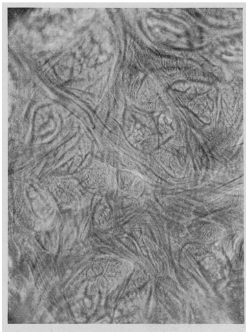
Abb. 82. Aufnahme eines Lederschnittes bei Verwendung von einer für subjektive Beobachtung bestimmten Mikroskopoptik (Vergr. 40,8mal).
