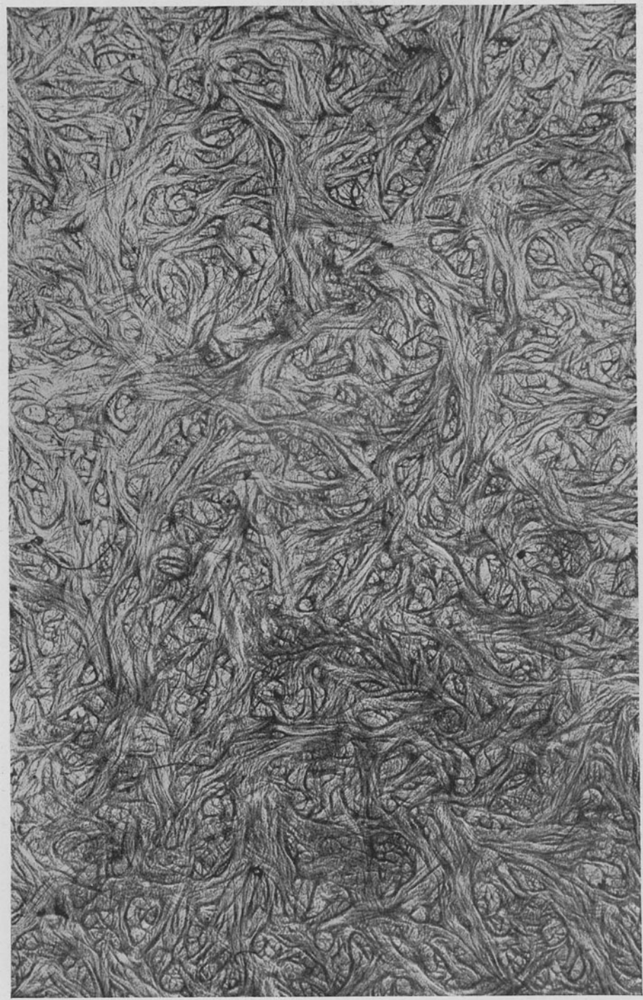
Abb. 140. Horizontalschnitt durch ein Kernlederstück, Rindshaut (Vergr. 40mal).
