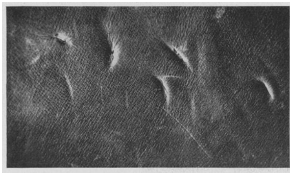
Abb. 397. Narbenseite eines Boxkalbleders mit Fleischerschnitten und Aushebern ( \frac{1}{2} nat. Gr.) [F. Stather (5)].
