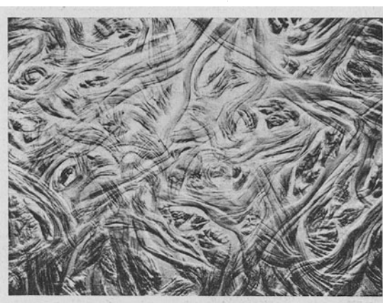
Abb. 174. Schnitt durch chromgegerbte Rindshaut (Vergr. 21mal).
