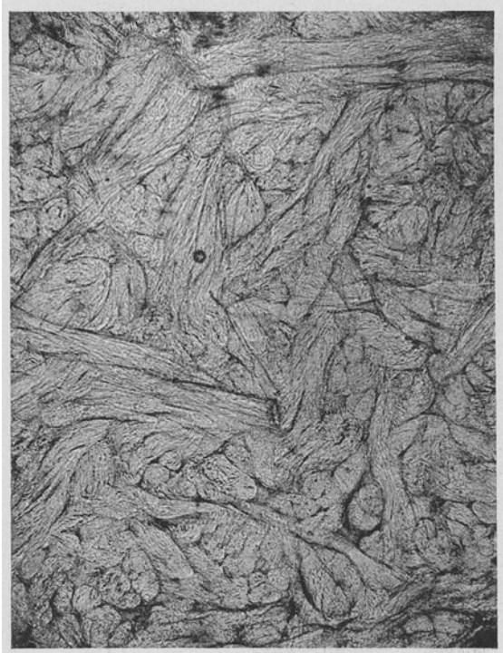
Abb. 178. Gefrierschnitt durch „Leimleder“ (mit CaO überäscherte Rindshaut) (Vergr. 27mal).
