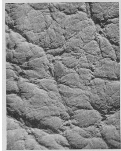
Abb. 222. Narbenbild des Pekari mit charakteristischer Hautpapille (genau in der Mitte des Bildes) (Vergr. 5,25mal).
