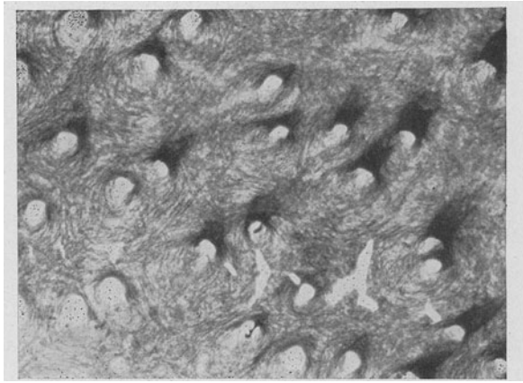
Abb. 94. Narbenpräparat eines narbenbeschädigten Leders im durchfallenden Licht (Vergr. 42mal).
