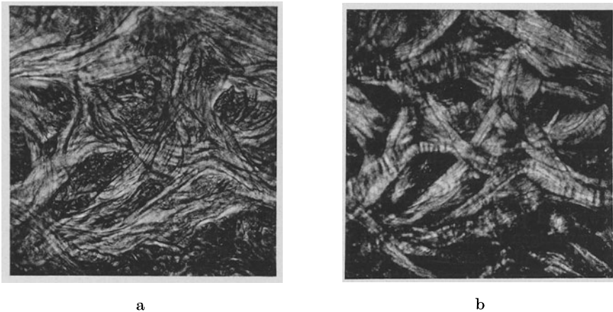
Abb. 149. Hautfasergeflecht der Rindshaut im unpolarisierten Licht (a) und im polarisierten Licht (b) (Gefrierschnitt, Vergr. 20mal).
