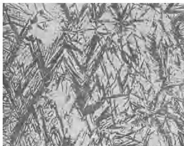
Abb. 23. Martensit. Stahl mit 0,8% C von 900° abgeschreckt. Vergr. 750 mal.
