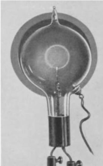
Abb. 1. Wehnelt'sches Demonstrationsrohr mit leuchtender Kathodenstrahlbahn. [Aus Z. physik. chem. Unterr. Bd. 18 (1905).]
