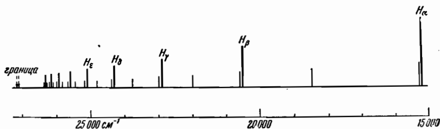
Рис. 145. Серия Бальмера и Пикеринга. Линии серии Бальмера изображены более длинными черточками.
