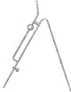
Fig. 3. Heber mit seitlich angesetztem Saugrohr.
