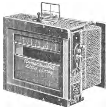
Fig. 302. Klappkamera mit festen Spreizen. (Den Verschuß zeigend.)
