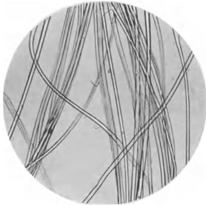
Abb. 210<sup>1</sup>. Feinfädige Kupferseide, nach dem Streckspinnverfahren hergestellt; in ihrem mittleren Durchmesser kommt diese Kunstseide der echten Seide gleich.
