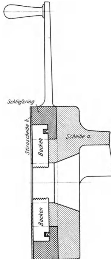
Fig. 637. Plan eines feststehenden Schneidkopfes.
