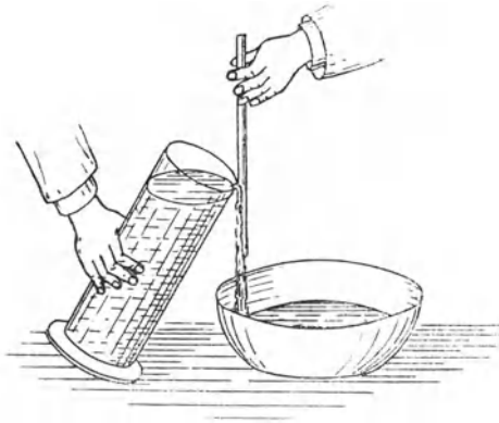
Abb. 2. Adhäsion beim Ausgiessen von Flüssigkeiten.
