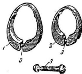
Фиг. 126. Ложевые кольца винтовки обр. 1891 г.
