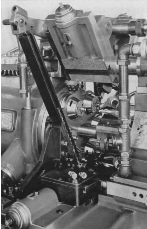
Abb. 9. Mehrspindel-Magazinautomat zur Herstellung von Verschraubungen.
