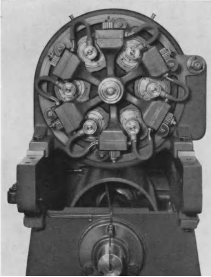
Abb. 108. Druckluftverteilung auf die sechs Spannzylinder eines Sechsspindelautomaten.
