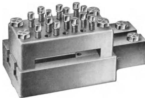
Abb. 186. Vielstahlhalter für Flachstähle.
