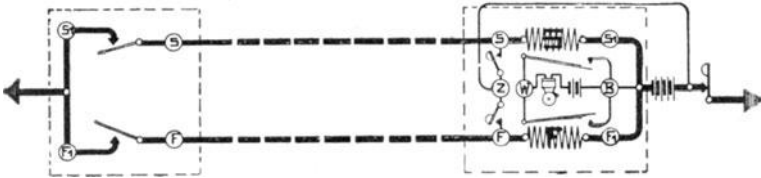
Abb. 400. Prinzipschaltung einer Wasserstandsfernmeldeanlage mit Doppelleitung.
