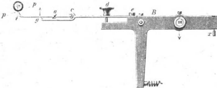
und zeigt zugleich (wie auch ein von Meller in Köln ausgestellt) die von Brabender (1869) angegebene, in Fig. 29 abgebildete Einrichtung des Schreibhebels, welche denselben sowohl für Arbeitsstrom als (nach dem Niederschrauben der Schraube *d*) für Ruhestrom verwendbar macht;
