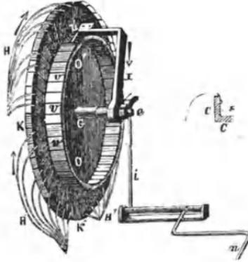
Hebescheibe ist ferner bei  $e$  auf die Welle  $G$  aufgesteckt, um mittels der Hebel  $i$  und  $n$  eine kleine Kugel auf einen Ständer aufschlagen zu
