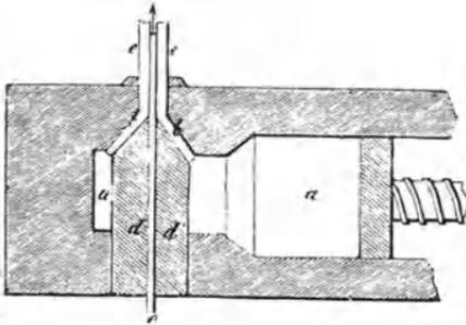
eines Schlauchs *ee* umhülle, wurde im Modell von Werner Siemens construirt und von ihm an Fourobert und Pruekner in Berlin abgetreten; mit nach diesem Modell gebauten Maschinen aber wurden nicht nur für die 1847 bis 1851 in Deutschland und Russland gelegten unterirdischen Linien die isolirten Drähte angefertigt, sondern mit ihnen werden auch jetzt noch für alle Untersee-Leitungen die Guttaperchadrähte hergestellt.
