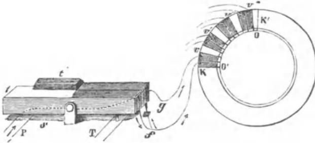
lassen, sowie der Schraubengang des betreffenden Apparates mit dem Schreiben eines Buchstabens fertig geworden ist, sowie also der Telegraphist ein neues Schriftzeichen (auf allen acht Tasten zugleich) greifen kann. Beim Niederdrücken einer schwarzen Taste  $t'$  geht der Strom von dem Batteriepole  $P$  (Fig. 50) in den metallischen Körper der Taste  $t'$  durch den Draht  $g$  nach dem ersten Felde hinter  $v$ ; wird dage-
