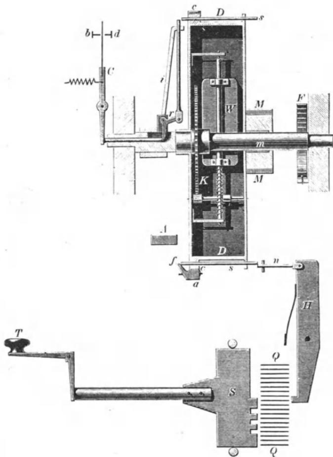
liegenden Stiften besetzt, welche sich mit einiger Reibung in ihrer Längsrichtung, d. h. parallel zur Dosenaxe *m* ein wenig verschieben lassen. Aus diesen Stiften werden die zu der automatischen Beförderung nöthigen Typen dadurch gebildet, dass eine bestimmte Anzahl derselben und in der entsprechenden Weise gruppiert beim Nieder-
