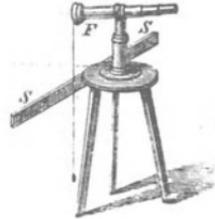
trieb mit galvanischen Strömen, sondern in der Form, welche er 1835 zum Telegraphiren mittels Magneto-Inductionsströmen erhalten hatte. Die Nadel in seinem Zeichenempfänger ist ein riesiger Magnetstab von 1,21 Meter Länge, 0,075 Meter Breite und 0,015 Meter Dicke; die ihn
