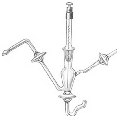
Abb. 30. Wasserstoffelektrode. Birnenform. 1/3 nat. Größe.
