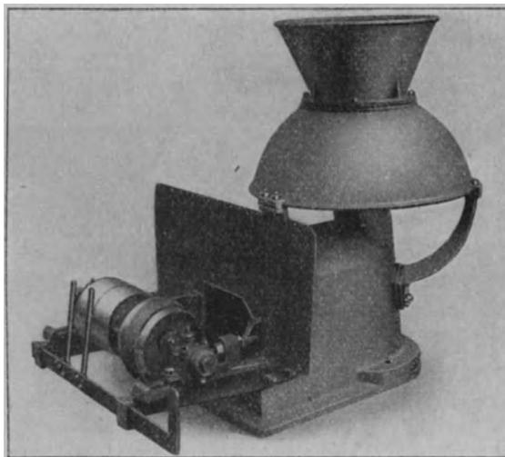
Abb. 119. Schleudermaschine mit wagerechtem Schleuderteller und mit Schutzgehäuse.
