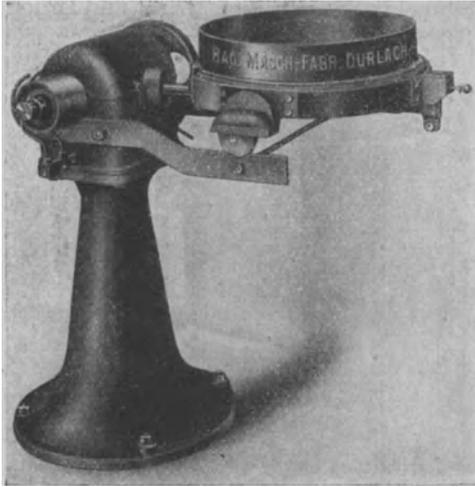
Abb. 108. Freistehendes Sieb mit Differentialrollenantrieb.
