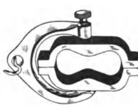
Abb. 50. Kernbüchse für Probekörper nach Henry M. Lane.
