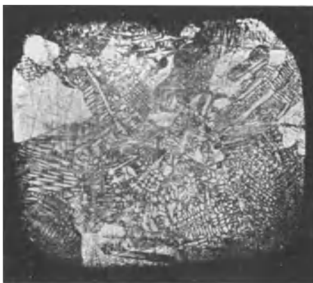
Abb. 3. Schnitt durch langsam erstarrten Silberkönig. Chrom-Schwefelsäure-Ätzung. Vergr. 3 ×.
