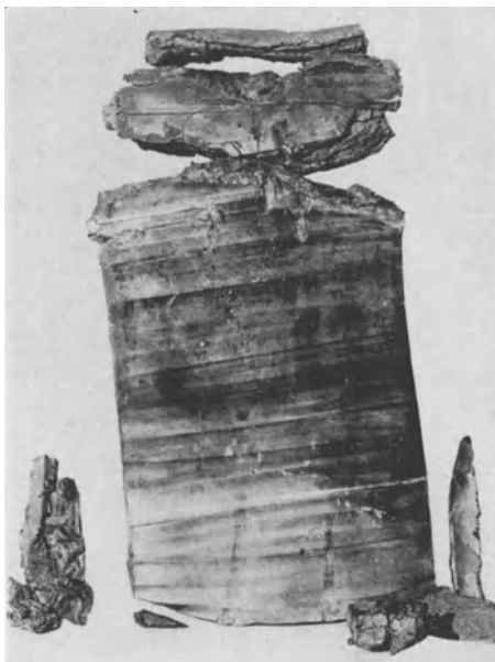
Abb. 60. Durch Überhitzen beim Warm Schmieden gebrochene Silber-Kupfer-Legierung (83,5 % Ag, 16,5 % Cu).
