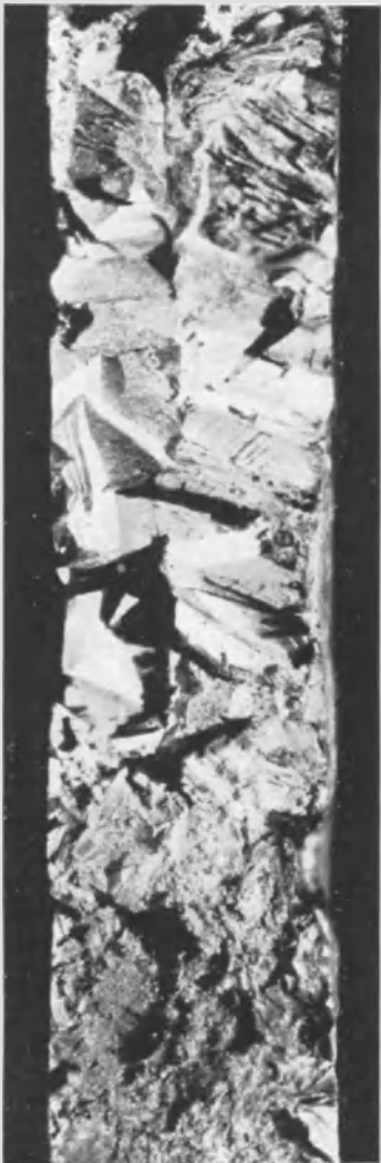
Abb. 59. Durch Warmrisse zerstörter Silber-Kupfer-Guß (90% Ag). Vergr. 3,5×.
