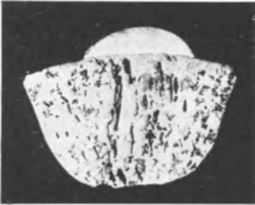
Abb. 43. Mit \text{SO}_2 begaste Schmelze 40% Ag, 60% Cu) nach langsamer Erstarrung mit ausgepreßter eutektischer Restschmelze. Vergr. 3,5\times .
