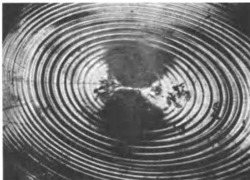
Abb. 14. Schrumpfungsringe auf der Oberfläche eines Goldbarrens. Vergr. 25 ×.
