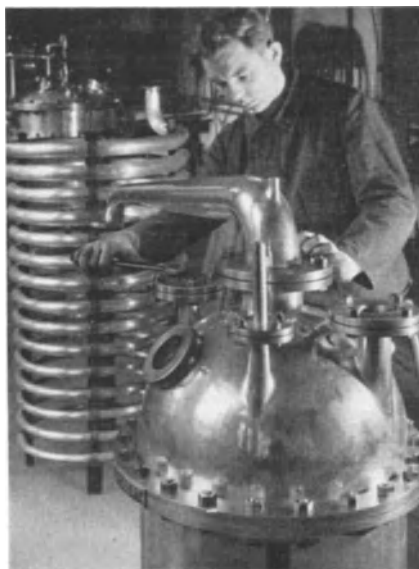
Abb. 6. Kühler und Destillationsblasen aus Silber bzw. mit Silber plattiertem Stahl. (Werkphoto Siebert.)
