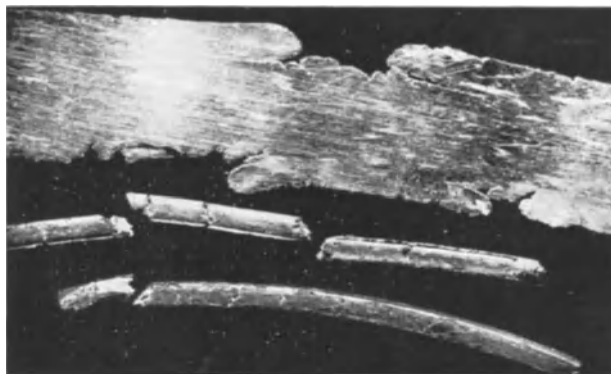
Abb. 81. Gerissene bleihaltige Gold-Legierungen. Blech 58,5% Au; 20,65% Cu; 20,65% Ag; 0,2% Pb. Draht 75,0% Au; 24,9% Cu; 0,1% Pb.
