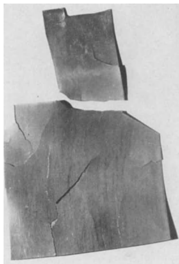
Abb. 106. Palladium-Gold-Blech (80 Au, 20 Pd) mit Phosphorbruch.
