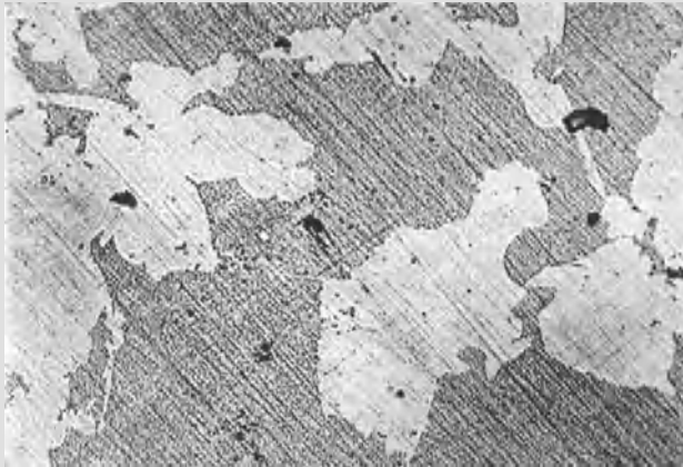
Abb. 46. Silber-Kupfer-Legierung mit 8% Cu 36 Std. bei 800° gegläht, dann in Wasser von Raumtemperatur abgeschreckt. Vergr. 280×.
