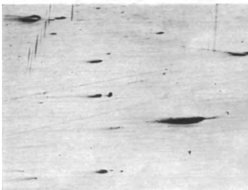
Abb. 52 a und b. Die Entstehung des „Kommasilbers“ durch harte Fremdeinschlüsse. a beim Schleifen herausgetretene Einschlüsse, b ausgebrochene Einschlüsse „Kommasilber“.
