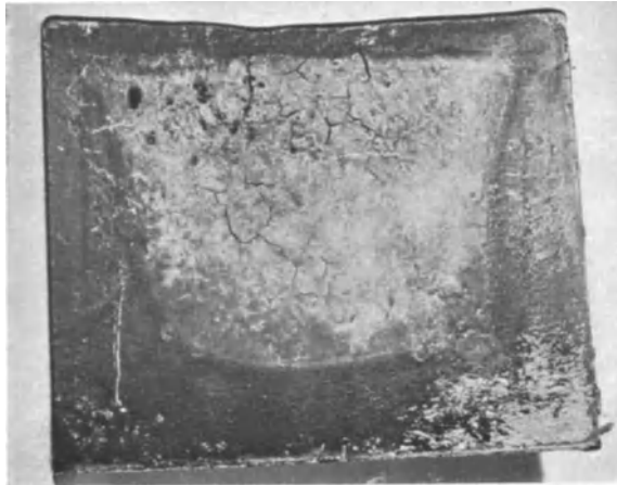
Abb. 55. Warmrisse in einer Silber-Kupfer-Legierung mit 83,5% Ag.
