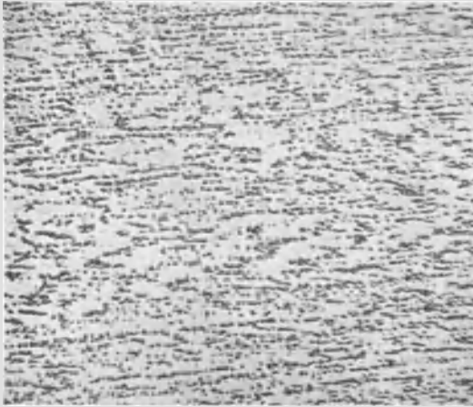
Abb. 50. Bearbeitete und gegläute Silber-Kupfer-Legierung mit 83,5% Ag. Vergr. 300×.
