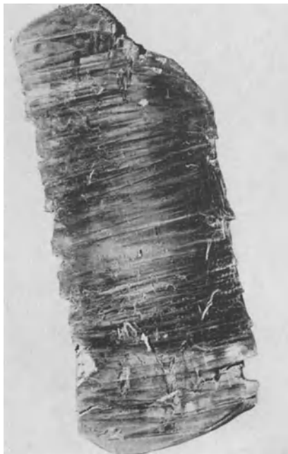
Abb. 58. Beim Warmschmieden sägezahnförmig aufgerissenes Gußstück (83,5% Ag, 16,5% Cu).
