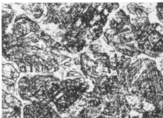
Abb. 116. Osmiridium-Perle. Ätzung: Wechselstromelektrolyse in 6 n-Schwefelsäure. Vergr. 800×.
