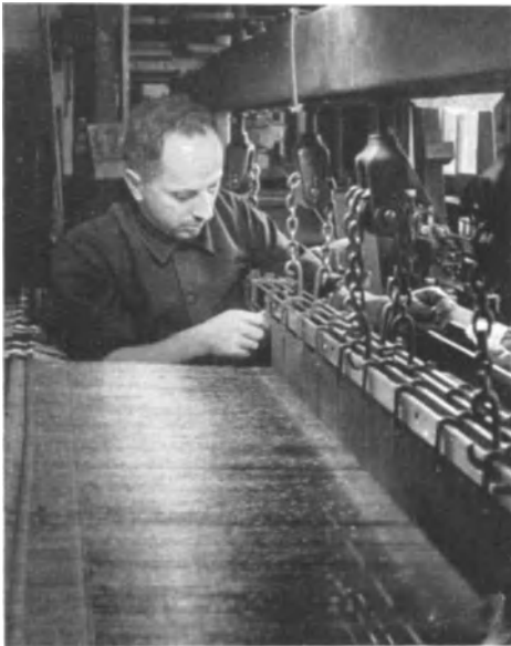
Abb. 32. Platinnetz-Webmaschine. (Werkphoto Siebert.)
