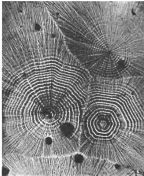
Abb. 41. Silber-Kupfer-Eutektikum, Sphärolithe. Vergr. 70 \times .
