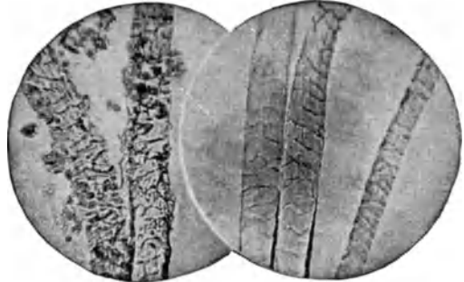
Fig. 82. Gewebefasern (von links nach rechts) gewaschen mit hartem und mit weichem Wasser.
