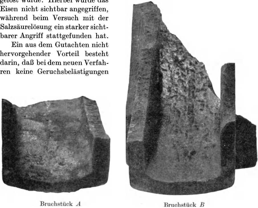
Fig. 86. Bruchstücke des Kesselglandes (nach Fig. 84 und 85) nach dem Lösungsvorgang.
