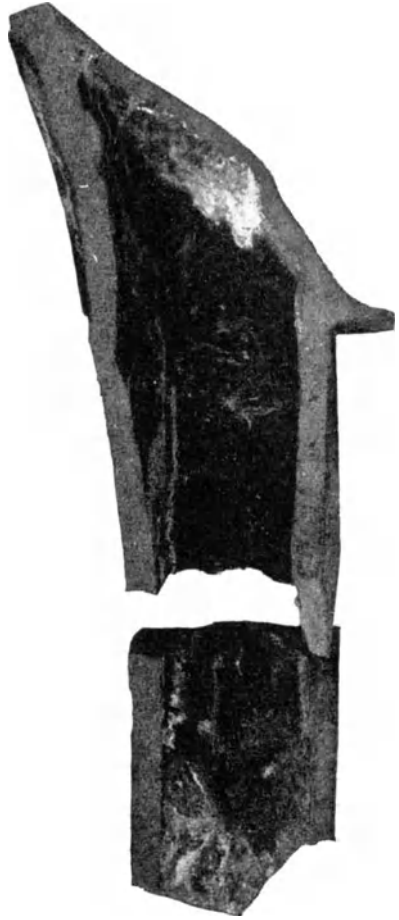
Fig. 84. Vom Staatlichen Material-Prüfungsamt untersuchte Gliederbruchstücke.
