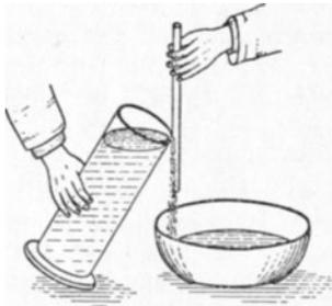
Abb. 23. Adhäsion des Wassers am Glasstabe.
