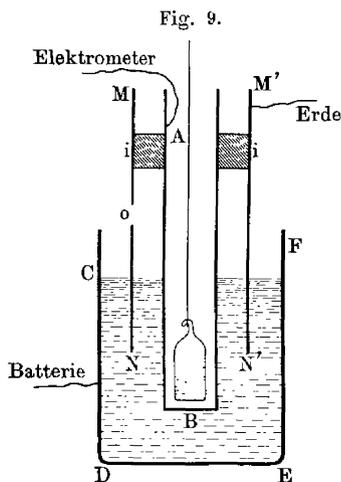
abzufangen. Ein Gefäß mit Radium-haltigem Baryumsalz kann in die Röhre *AB* eingesenkt werden; die Strahlen wirken auf die Flüssigkeit, nachdem sie das Glas des Gefäßes und die Metallwände der Röhre durchsetzt haben. Man kann das Radium auch wirken lassen, indem man das Glasgefäß unter den Boden *DE* legt.
