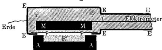
vollständig von dem Isolirmittel *iiii* umgeben; das ganze ist von einer Metallhülle *EEEE* umgeben, die in leitender Verbindung mit der Erde steht. Auf einer Seite der Scheibe sind Isolirschicht *pp* und Metallhülle sehr dünn. Diese Seite ist der Strahlung des Radium-haltigen Baryumsalzes *R* ausgesetzt, das sich frei in einem Bleitrog befindet <sup>3)</sup>. Die von dem Radium emittirten
