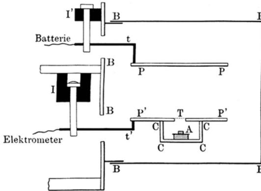
ist, und wirkt auf die Luft im Kondensator durch ein Metallnetz  $T$  hindurch; nur die das Metallgewebe durchsetzenden Strahlen werden zur Stromerzeugung benutzt, da das Feld an dem Gewebe endigt. Die Entfernung  $AT$  des aktiven Körpers von dem Gewebe ist veränderlich. Das Feld zwischen den Platten wird durch eine Batterie erzeugt; der Strom wird mittels eines Elektrometers und eines piezoelektrischen Quarzes gemessen.
