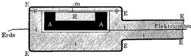
Bei dieser Anordnung beobachtet man am Elektrometer, daß das Radium eine positive Ladung von gleicher Größe annimmt, wie die negative bei dem ersten Versuch. Die Strahlen des Radiums durchdringen die dünne Schicht *pp* und nehmen beim Verlassen des inneren Leiters negative Elektrizität mit sich fort.
