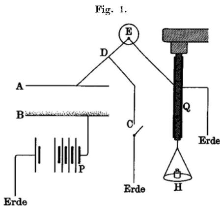
von Gewichten auf eine Schale *H*: diese Zugkraft wird allmählich hervorgebracht und bewirkt eine allmähliche Entwicklung einer bekannten Elektrizitätsmenge während der Dauer der Messung. Der Vorgang kann derart reguliert werden, daß in jedem Augenblick eine Kompensation stattfindet zwischen der den Kondensator durchfließenden und der entgegengesetzten vom Quarz herrührenden Elektrizitätsmenge<sup>1)</sup>. Man kann so in absolutem Maße die während einer
