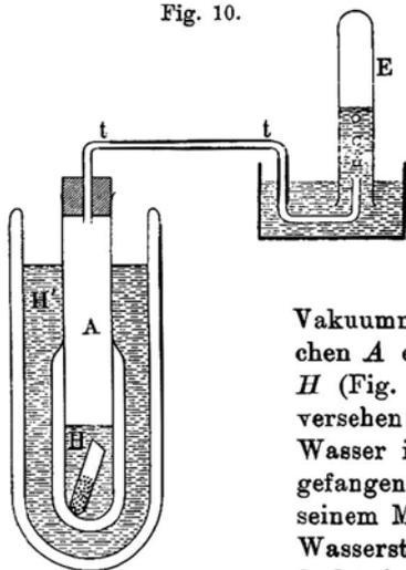
mißt. Man kann den Versuch mit Methylchlorid ausführen (bei  $-21^{\circ}$ ). Die Herren Dewar und Curie führten den Versuch mit flüssigem Sauerstoff (bei  $-180^{\circ}$ ) und mit flüssigem Wasserstoff (bei  $-252^{\circ}$ ) aus. Der Wasserstoff eignet sich besonders gut zu dem Versuch. Ein mit einem
