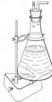
Abb. 3. Inversionsgefäß zur Bestimmung des Säuregrades des Weines.
