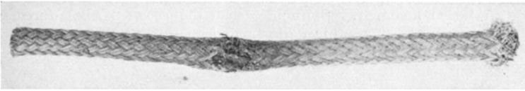
Abb. 21. Durchgeschmortes Kabel (Panzerader), das zu einem größeren Brande die Ursache war.
