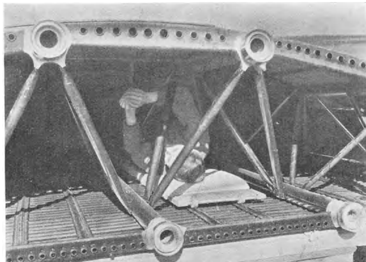
Abb. 55. Der Flügel des Junkers-Flugzeuges gestattet, wie das Bild zeigt, das Befahren des Flügelinnern mit kleinen Wagen, so daß eine gründliche Kontrolle aller Einzelheiten gewährleistet ist.
