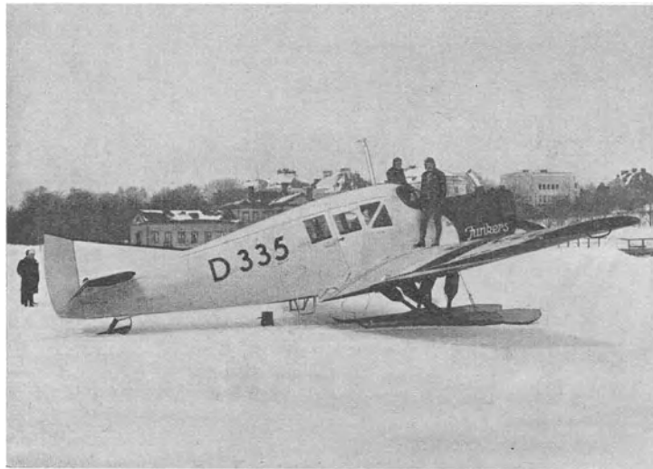
Abb. 53. Bei den Junkers-Flugzeugen ist auch der Ersatz der Anlaufräder durch Schneekufen vorgesehen. Das Bild zeigt eine mit Schneekufen ausgerüstete F 13 in Helsingfors.
