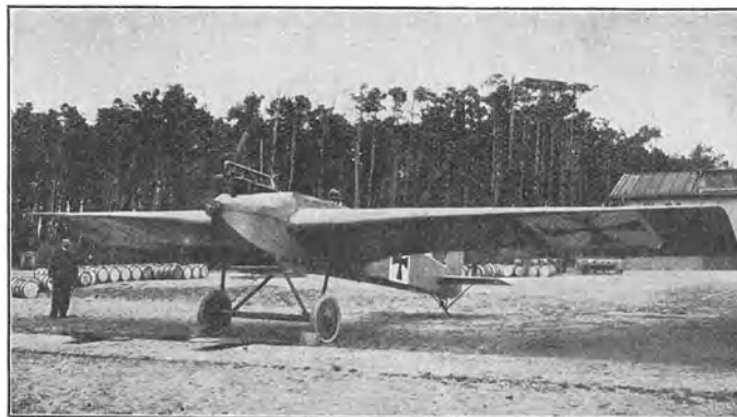
Abb. 43. Junkers-Eisenetdecker J 1 aus dem Jahre 1915. Erstes Flugzeug in Ganzmetallbauart und mit verspannungslosen freitragenden Flügeln.
