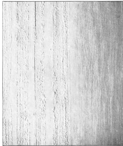
Abb. 3. Weißlackierung zeigt in dreifacher Vergrößerung links die Wucherungen infolge Quellens der Ölteile.
