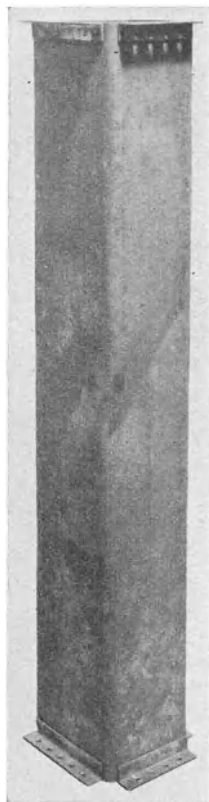
Abb. 12. Einknicken der Wände bei Verdrehung.
