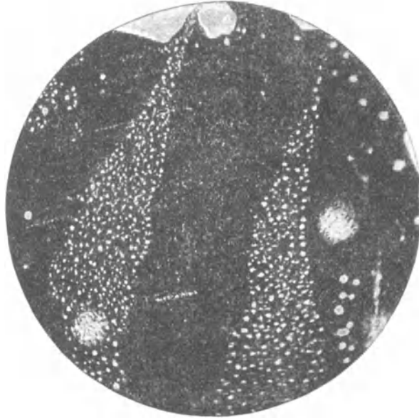
Fig. 37. Polierter Anschliff. Mit \text{HNO}_3 1:1 geätzt. Vergr. 300:1. Grube Hilfe Gottes bei Grund im Harz. Silberglanz in Form weißer Tröpfchen auf einzelnen Zonen des Bleiglanzes (dunkel angeätzt). Sie bilden die Ursache des primären Silbergehalts des Bleiglanzes und haben sich aus ihm durch Entmischung abgeschieden.
