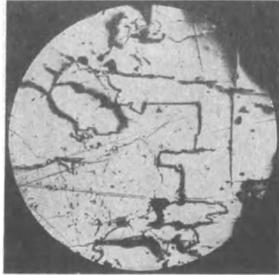
Fig. 65. Gersdorffit, Wolfsberg, ungeätzt. Rechts Gersdorffit heller als Bournonit, in den er idiomorph eingreift. Die würfelige Spaltbarkeit des Gersdorffits ist in einzelnen kräftigen, langen Spaltrissen und dreieckigen Ausbrüchen gut zu erkennen. (Nach W. Flörke.)
