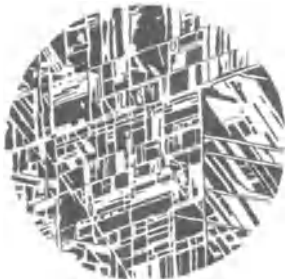
Fig. 10. Vergr. 19 : 1. Mikrophoto von „Lamellarem Kupferglanz“ im auffallenden Licht, überzeichnet. Größere Lamellen weiß, die feinlamellierte Zwischenmasse schwarz. (Nach H. Schneiderhöhn). Fig. 11. Vergr. 33 : 1.
