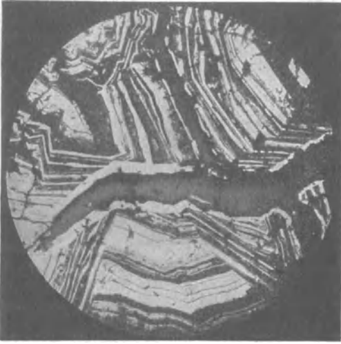
Fig. 68. Speiskobalt von Schneeberg, geätzt mit konz. \text{HNO}_3 . Vergr. 50:1. Breite Quarzadern von jüngerem weißen, nicht durch \text{HNO}_3 angegriffenem Speiskobalt umsäumt. (Nach W. Flörke.)
