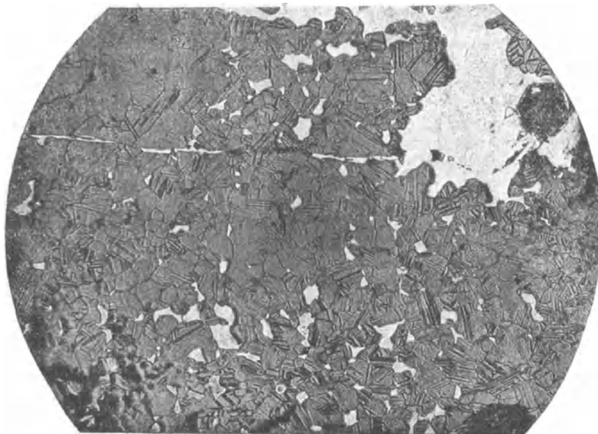
Fig. 28. Polierter Anschliff. Geätzt mit schwefelsaurer Permanganatlösung. Vergr. 80:1. Zinkblende (grau) und Bleiglanz (weiß) von Holzappel in Nassau. Zinkblende als allotriomorphes Aggregat, alle Körner mit Zwillingslamellierung. Bleiglanz verdrängt als jüngerer azzendentes Erz die Zinkblende allmählich.
