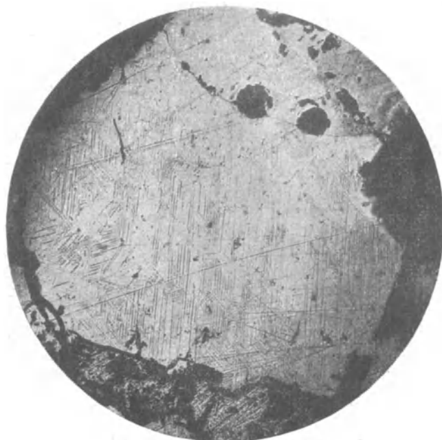
Fig. 20. Polierter Anschliff. Mit schwefelsaurer Permanganatlösung geätzt. Vergr. 36:1. Radebek im Kaukasus, Siemenssche Kupfergruben. Kupferkies mit komplizierter Zwillinglamellierung. (Nach H. Schneiderhöhn.)
