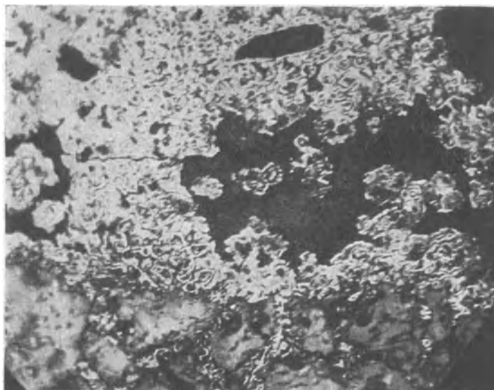
Fig. 56. Polierter Anschliff; Markasit von Wiesloch in Baden. Geätzt mit schwefelsaurer Permanganatlösung, zeigt Achatstruktur (weiße und dunkle Bänder). Mit Zinkblende verwachsen (schwarz). Nach H. Schneiderhöhn.
