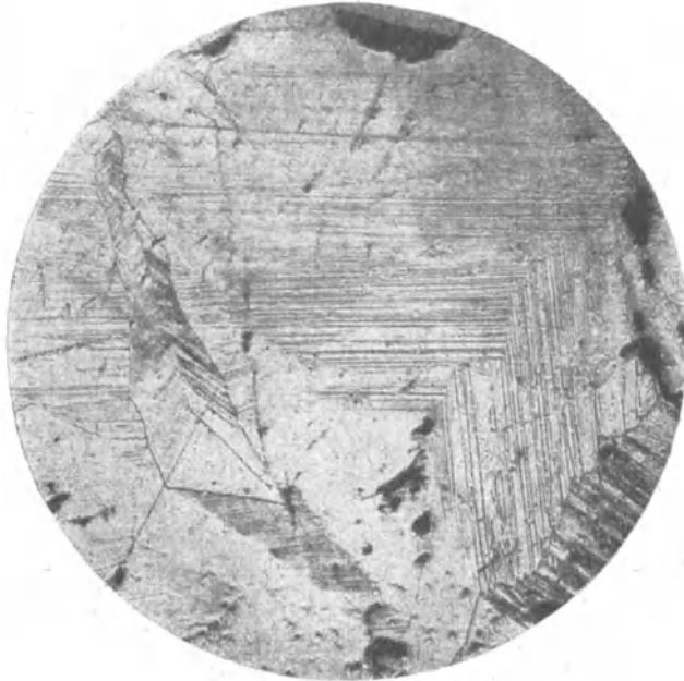
Fig. 60. Polierter Anschliff. Geätzt mit alkal. Permanganatlösung. Vergr. 48:1. Arsenkies von Freiberg i. S. Zwillingslamellen in zwei Systemen eingelagert. (Nach H. Schneiderhöhn.)
